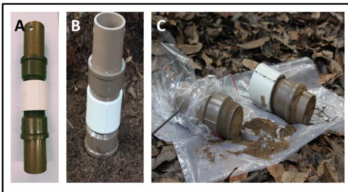
Figura 5. Amostrador de solo composto por tubo e conexão roscável em policloreto de vinila (PVC) utilizado para coleta de amostras de solo no período seco. A. Tubo e conexão roscável; B. Amostrador parcialmente penetrado no solo; C. Partes do amostrador desconectadas após coleta e seccionamento do perfil do solo.
