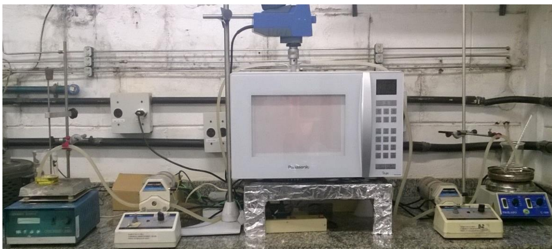
FIGURA 5.20 - Sistema de MW + RPB e seus aparatos para a produção de biodiesel em fluxo contínuo.
