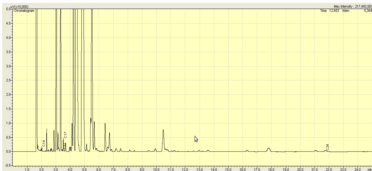
FIGURA 5.18 – Cromatograma obtido para mistura de ésteres etílicos em biodiesel de óleo de soja com base em metodologia EN14103.
