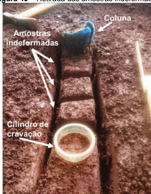
Figura 49 – Retirada das amostras indeformadas
