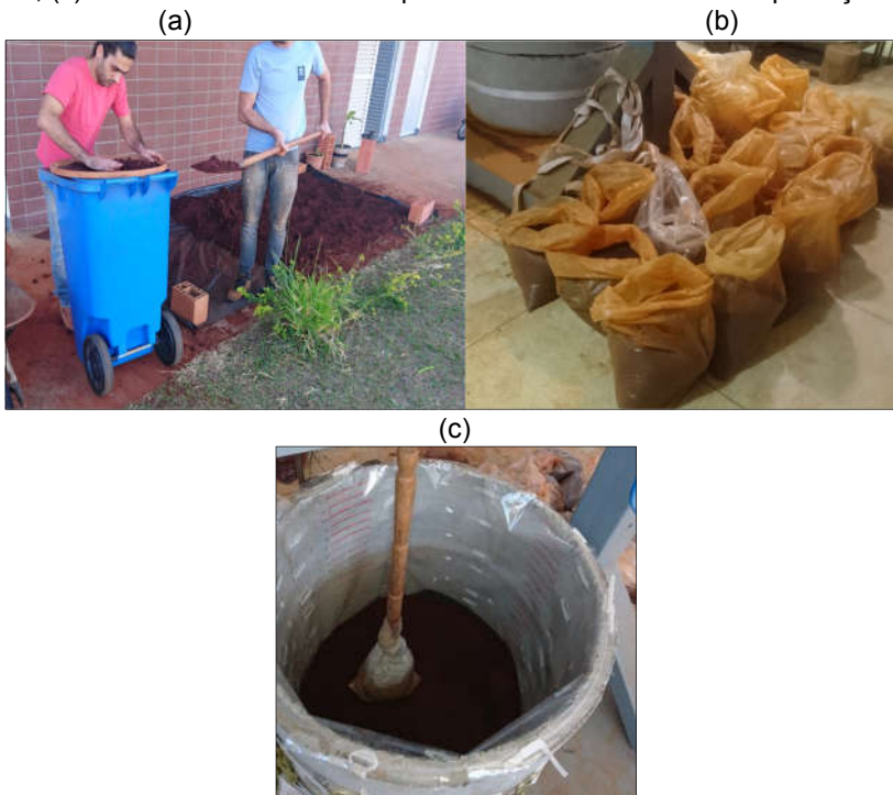
Figura 26 – Preparação do solo: (a) Peneiramento do solo; (b) separação do solo por lotes em sacos plásticos; (c) marcas de 5 centímetros para facilitar e controlar a compactação do solo
