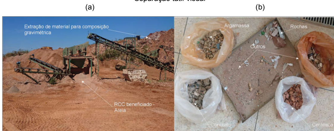
Figura 17 – (a) Coleta de material para composição gravimétrica e utilização na pesquisa; (b) Separação tátil-visual
