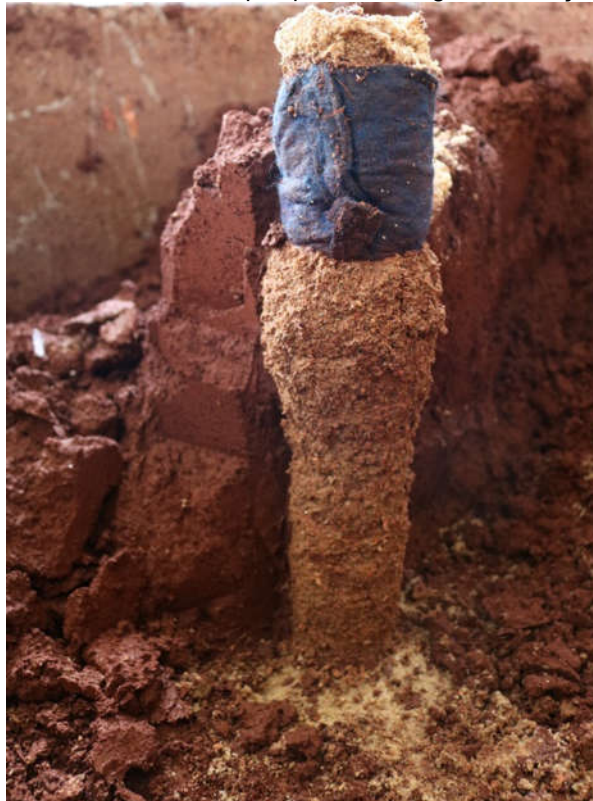
Figura 55 – Coluna exumada após prova de carga na condição inundada
