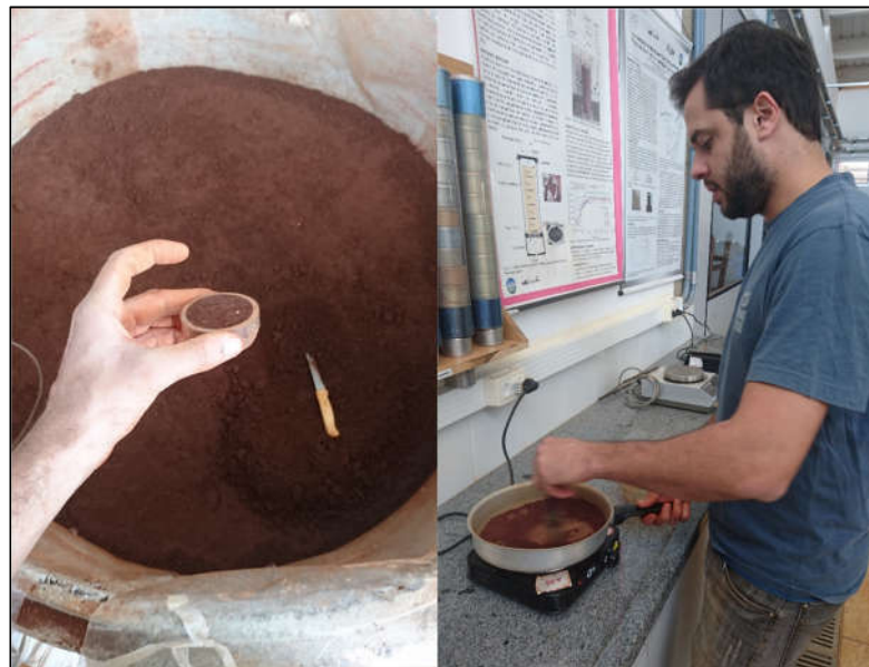
Figura 27 – Controle de compactação: (a) Cilindro de aferição de compactação; (b) Umidade após compactação – método da frigideira
