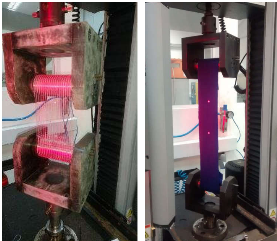
Figura 24 – Ensaio de tração realizados no DEMA/UFSCar: (a) geogrelha; (b) geotêxtil
