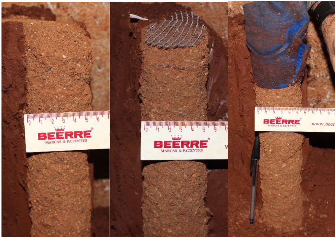
Figura 50 – Exumação das colunas após instalação: (a) coluna RCC; (b) coluna RCC + GGH; (c) coluna RCC encamisada
