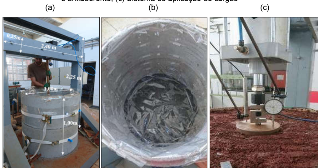
Figura 12 – (a) Pórtico de reação e câmara de ensaio; (b) Celulose revestindo as paredes da câmara e antiaderente; (c) Sistema de aplicação de cargas
