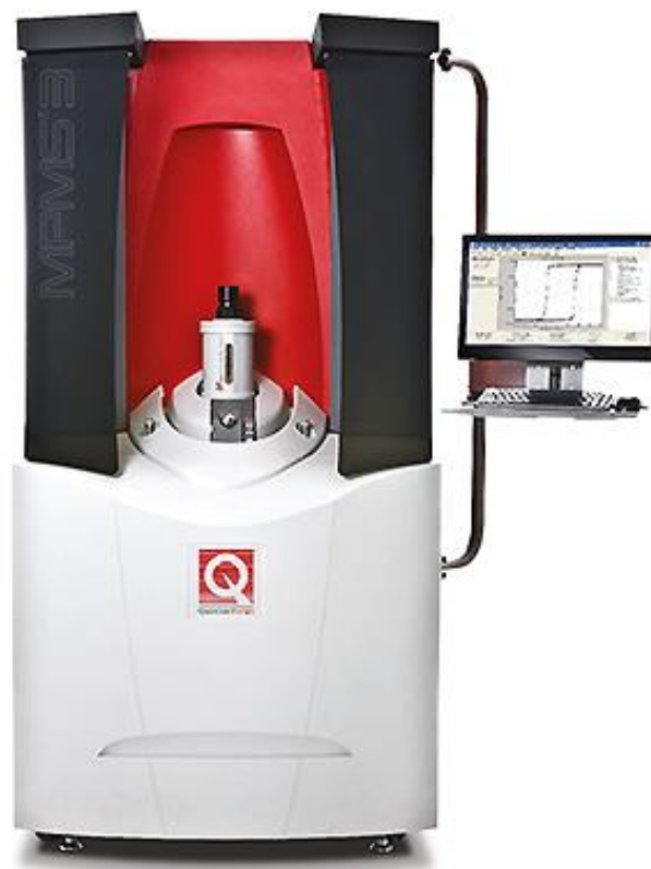
Figura 4.1.1 – Sistema geral do magnetômetro MPMS3 VSM SQUID para realização das medidas magnéticas. A remanência da bobina é \sim 30 Oe ( \sim 0,003 T). (Fonte: Imagem copiada do manual da Quantum Design [62])
