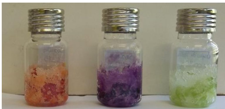
FIGURA 3. 11: Frascos de 10 mL contendo amostras de 1 g de pimenta juntamente com 2 g de sal \text{Na}_2\text{SO}_4 preparados para análise por headspace .
