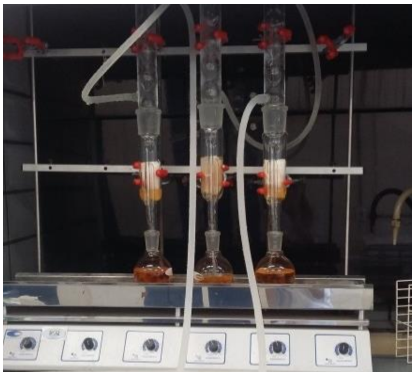
FIGURA 3.9: Extração de óleo essencial de pimenta por soxhlet.
