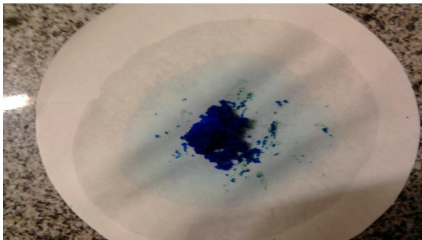
Figura 40- Fotografia do GR31 após do contato com a solução de íons \text{Cu}^{+2} em pH 10.
