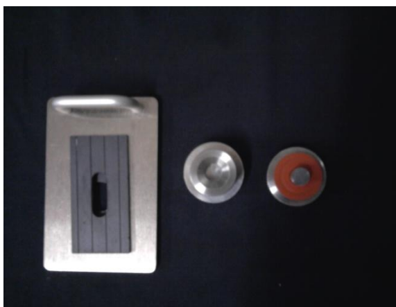
Figura 11-Dispositivo para fazer as pastilhas para análise de FTIR.
