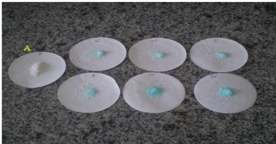
Figura 39- Fotografia do GR11 antes do contato com a solução de íons \text{Cu}^{+2} (A) e após 2, 4, 6, 8, 10 e 20 minutos de contato com a solução de íons \text{Cu}^{+2} em pH 4,5.
