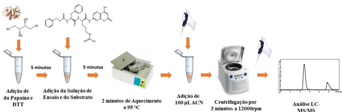
FIGURA 4. 7. Procedimento experimental do ensaio em solução da papaína. Proteína (estrutura da papaína da Carica papaya ) disponível em: < https://www.iycr2014.org/learn/crystallography365/articles/20140620 > Acessado em: 26. Jun. 2019.
