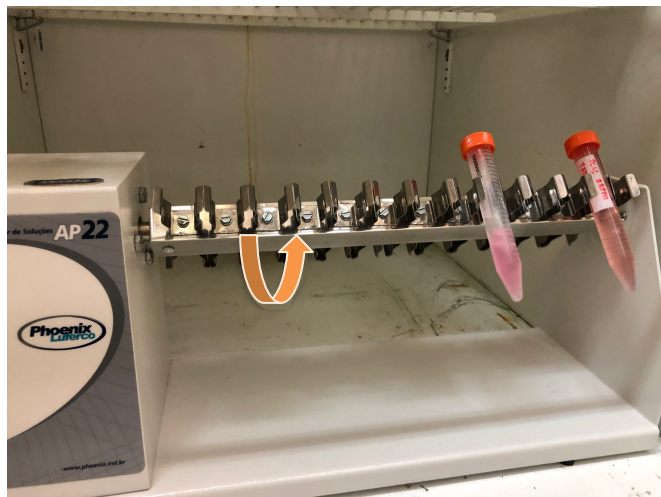
Figura 24: Equipamento de baixa rotação para promover interação entre resina e anticorpos.
