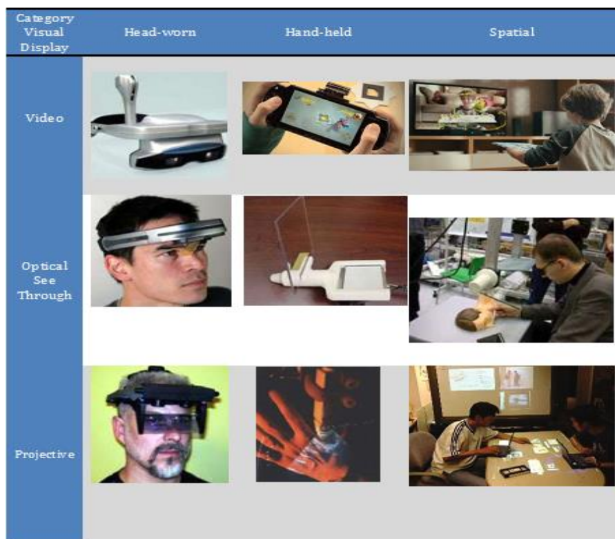
Figura 2.10: Classificação dos tipos de Visual Display de RA. (TOBAR et al., 2013)
