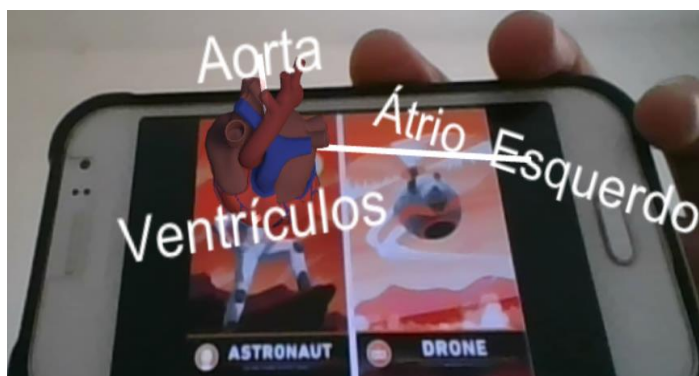
Figura 6.6: Cenário final quando o marcador adicional (ou de controle) é colocado junto ao marcador principal (ambos os marcadores são visíveis), permitindo ativar a informação adicional.
