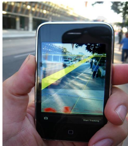
Figura 2.5: Exemplo de VST Display através de um dispositivo móvel. (REALIDAD AUMENTADA, 2017)
