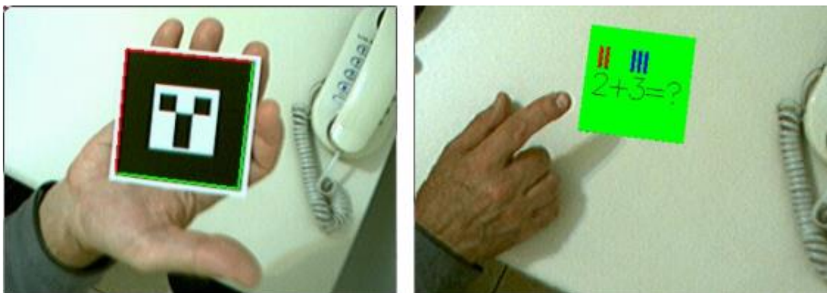
Figura 2.17: A figura esquerda apresenta o marcador principal ainda sem ser reconhecido pelo sistema, já na figura direita o marcador principal é reconhecido pelo sistema e apresenta a imagem em RA com a pergunta. (KIRNER, 2013)
