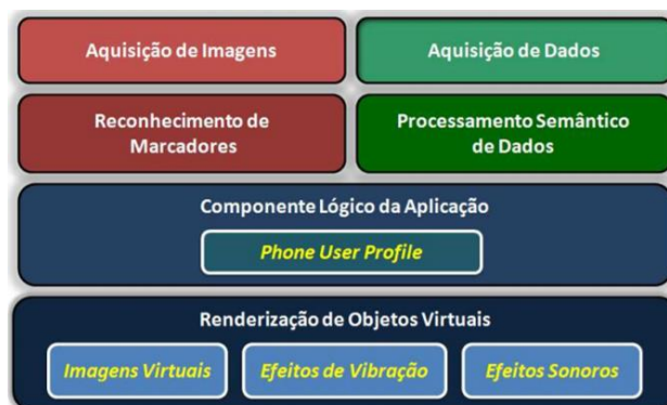
Figura 3.2: Arquitetura proposta para aplicações de tipo Hand-held AR que usam sensores com interfaces de comunicação sem fio. (ZUÑIGA TORRES, 2008)
