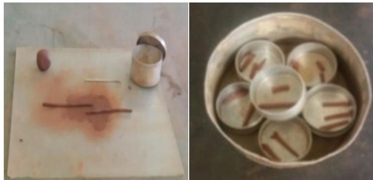
Figura 23. Ensaio de limite de plasticidade (AUTOR, 2018).
