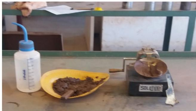
Figura 22. Ensaio de limite de liquidez (AUTOR, 2018).
