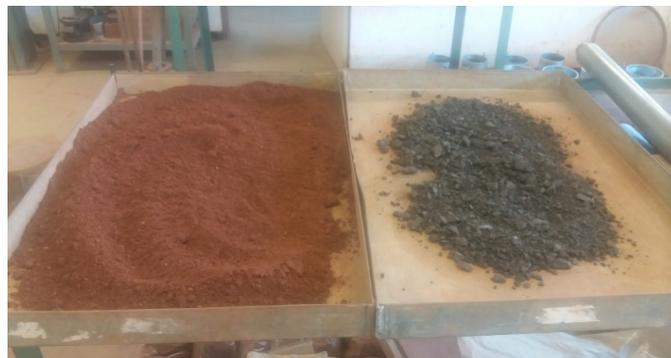
Figura 15. Material fresado sendo adicionado ao solo (AUTOR, 2018).
