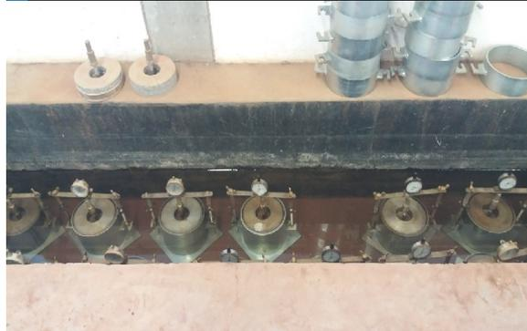
Figura 16. Corpos de prova imersos para análise da expansão (AUTOR, 2018).
