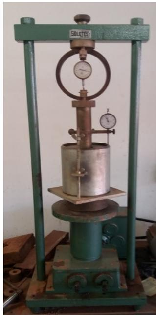
Figura 17. Ensaio de resistência ISC (AUTOR, 2018).
