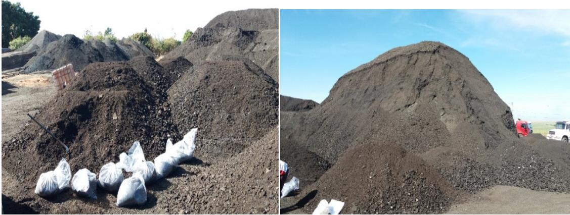
Figura 9. Coleta do material fresado de revestimento asfáltico (AUTOR, 2017).
