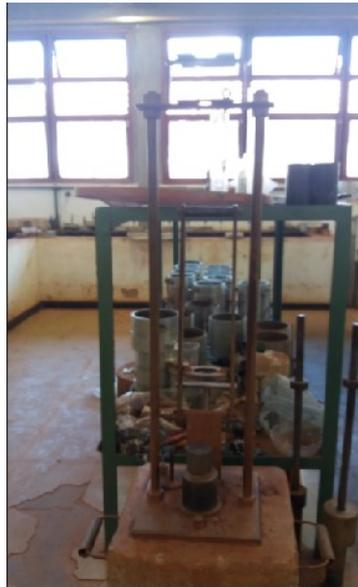
Figura 12. Esquema de compactador MCV. (AUTOR, 2018).
