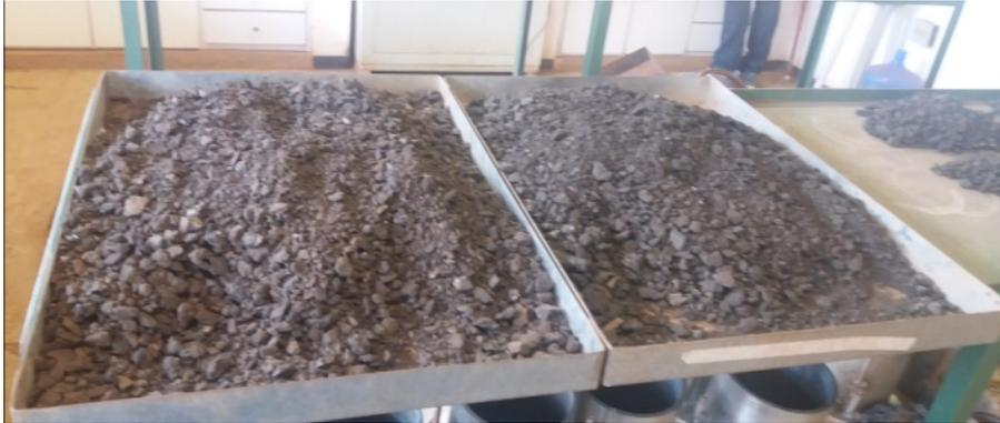
Figura 11. Material fresado seco ao ar. (AUTOR, 2018)
