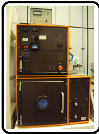
Figura 2.11 Equipamento utilizado para expor os substratos a plasma de oxigênio.
