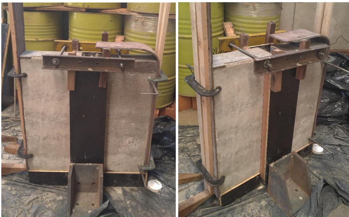
Durante a concretagem deste modelo piloto houve grande dificuldade no preenchimento dos alvéolos da laje: apesar da alta trabalhabilidade do concreto, não houve preenchimento total dos alvéolos (Figura 4.8a). As falhas de preenchimento dos alvéolos da laje do modelo piloto indicaram a necessidade de utilizar outra estratégia nos modelos definitivos.
