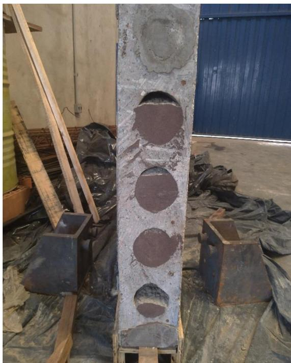
a) Falhas no preenchimentos dos alvéolos da laje: modelo piloto
