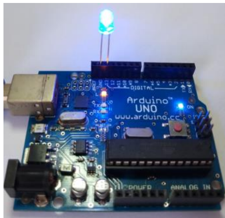
Figura 3 - LEDs acesos. LED laranja da placa e LED azul conectado ao pino 13 acendendo durante execução do programa da figura A.2.
