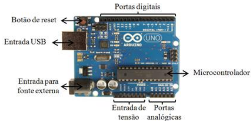
Figura 1 - Placa Arduino UNO com especificações de entradas e saídas.
