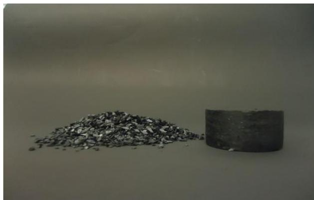
Foram pesadas 20g da mistura para cada amostra, onde sua homogeneização foi feita através do auxílio de um bastão de vidro, e colocada na estufa (70 +/- 2°C) por 10 minutos para que a parafina se fundisse no fino de carvão vegetal.
