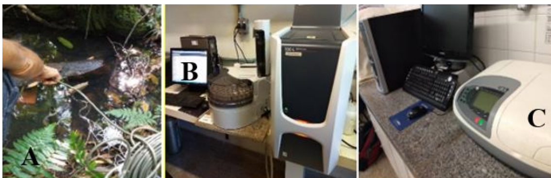
Figura 15: Equipamentos utilizados nas análises das variáveis físicas e químicas. Sonda multiparamétrica Horiba U10 (A), TOC Shimadzu, modelo TOC-L SSM 5000), com temperatura 700°C (B) e Espectrofotômetro (C) (Foto: Daniele Cristina Schiavone).
