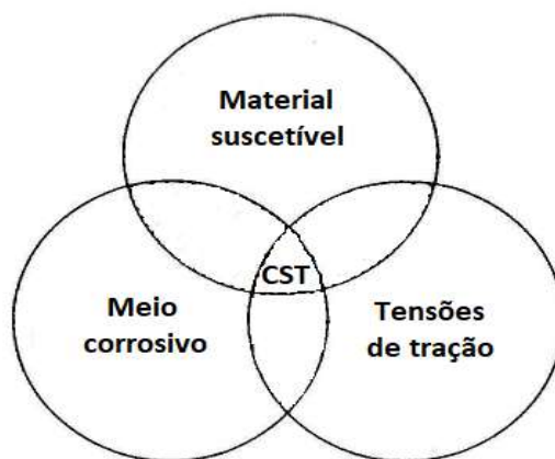
Figura 2-11: Fatores necessários para ocorrência de CST em uma liga.
