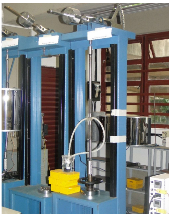
Figura 3-12: Sistema para ensaio de CST adaptado à máquina de fluência.
