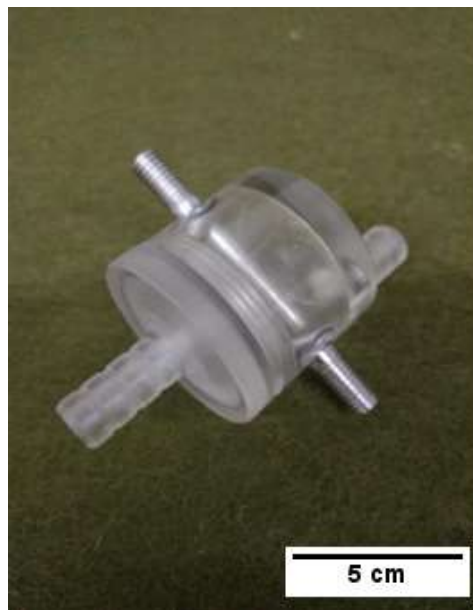
Figura 3-9: Câmara desenvolvida para realização dos ensaios de CST.
