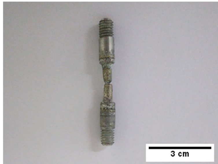
Figura 4-41: Aspecto do CP da liga Al-4%Cu na condição 0x fraturado em ensaio de CST com carga constante após 240h de ensaio em 70% do limite de escoamento.
