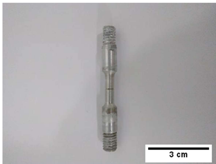
Figura 4-12: Aspecto do CP da liga AA1050 na condição 0x não fraturado em ensaio de CST com carga constante em meio salino após 480h de ensaio em 90% do limite de escoamento.
