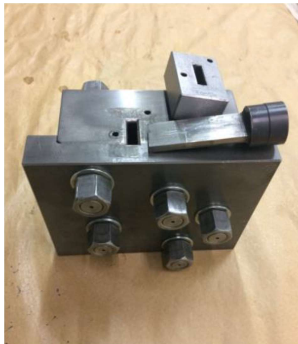
Figura 3-3: Matriz utilizada para processamento ECA de chapas.
