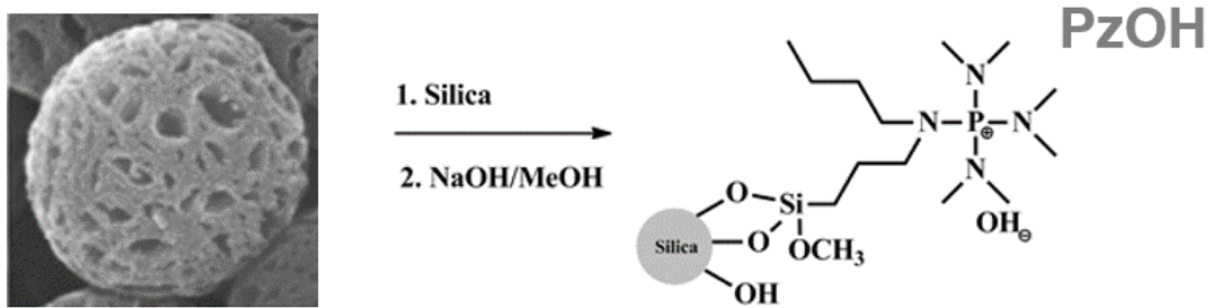
Figura 15. Esquema da funcionalização de esferas rugosas de sílica com grupos hidróxido de fosfazênio para reações de transesterificação.
