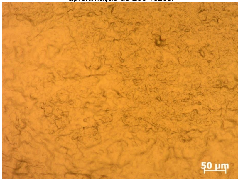
Figura 31 - Micrografia do filme LbL de quitosana/CMC de 20 bicamadas, com aproximação de 200 vezes.
