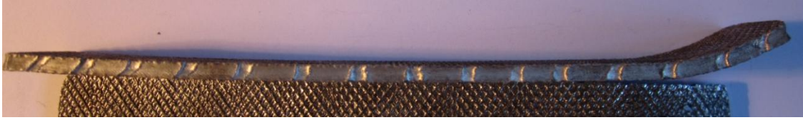
Figura 51 - Amostra LARD com 50% de redução de espessura.
