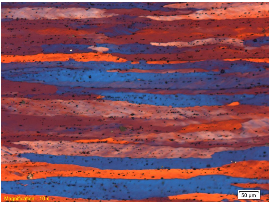
Figura 38 - Micrografia de luz polarizada da amostra ECA de 0X (como recebido).
