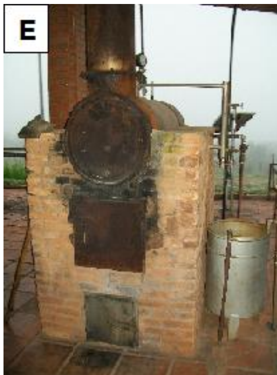
Figura 14 – Alambiques. A – Alambique tipo cebolão e pré-aquecedores; B – Vinho deslevedurado dentro do pré-aquecedores; C – Parte do coração da cachaça; D – Ancorote para descanso de cachaças (5L) e E – Caldeira.
