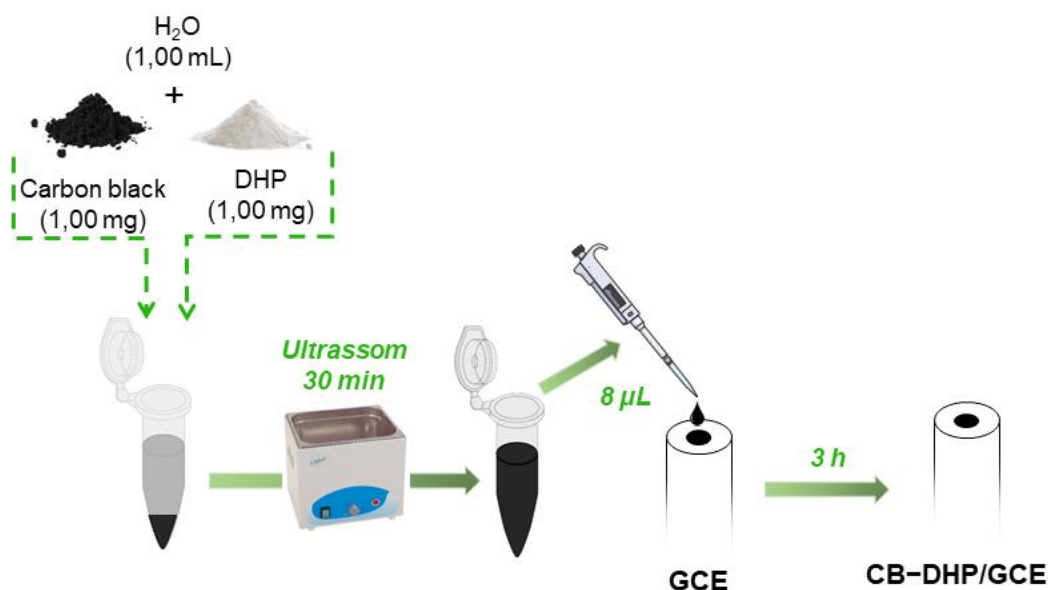
FIGURA 4.1 – Representação esquemática das etapas de preparo do eletrodo de trabalho.
