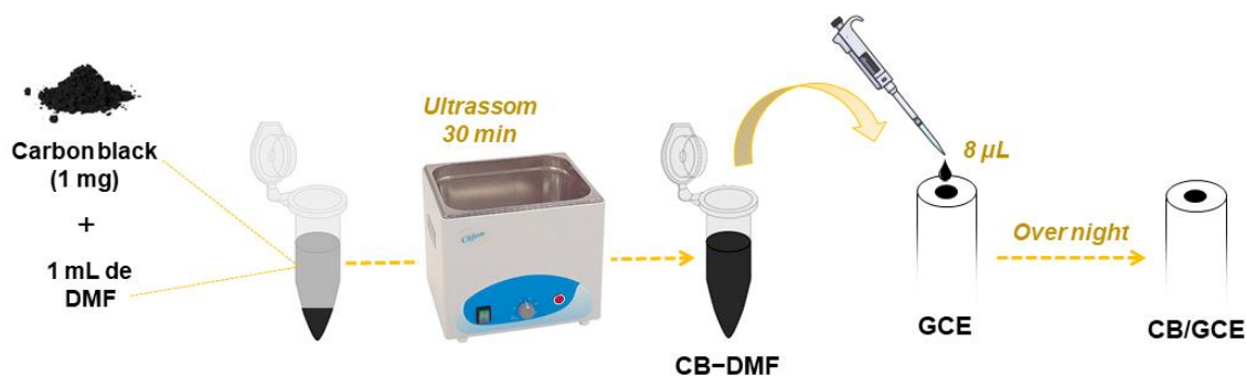
FIGURA 3.2 – Representação esquemática das etapas de preparo do eletrodo de trabalho.
