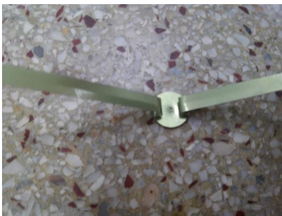
Figura 20 – Depressão feita com prego e martelo no centro da parte circular do grampo sem furá-lo.
