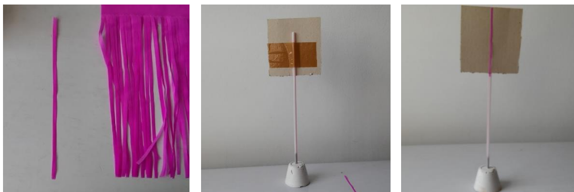
Figura 29 – Montagem do eletroscópio mostrando da esquerda para a direita, a retirada do papel de bala, a colagem do canudo no papel cartão e a fita colada.
