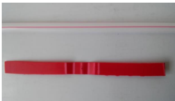
Figura 25 - Fita plástica dobrada na posição do seu centro de massa para a construção do versório de Assis.
