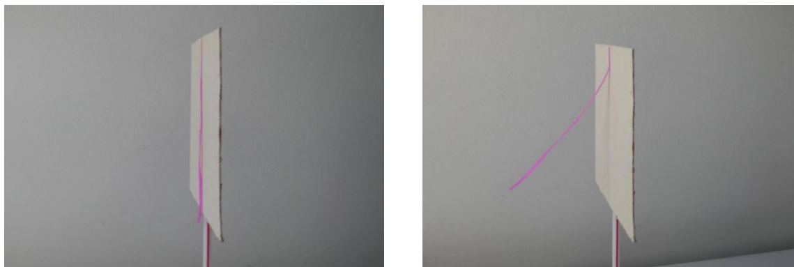
Figura 30 – À direita mostramos a vista lateral do eletroscópio e à esquerda o eletroscópio carregado utilizando o indutor.
