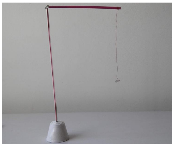
Figura 16 – Pêndulo elétrico composto pela base de gesso, canudos, fio de seda e pedaço de papel em forma circular.
