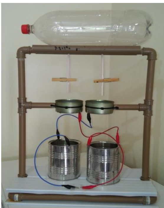
Figura 10 – Gerador Eletrostático de Kelvin montado.
