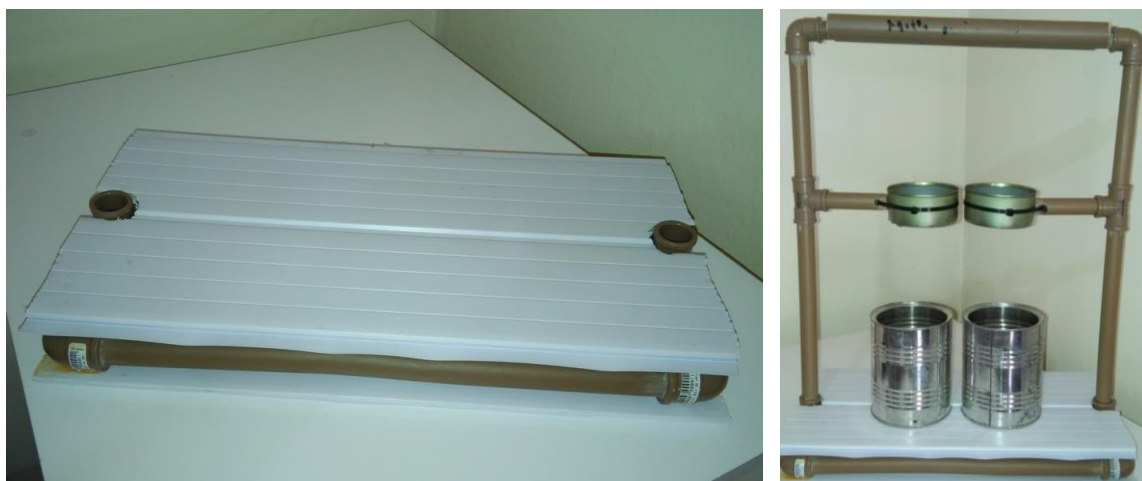
Figura 37 – À esquerda mostramos a base da estrutura do gerador revestida com chapas de forro de PVC e à direita são mostrados os reservatórios inferiores, compostos por duas latas de leite, sobre a base revestida.
