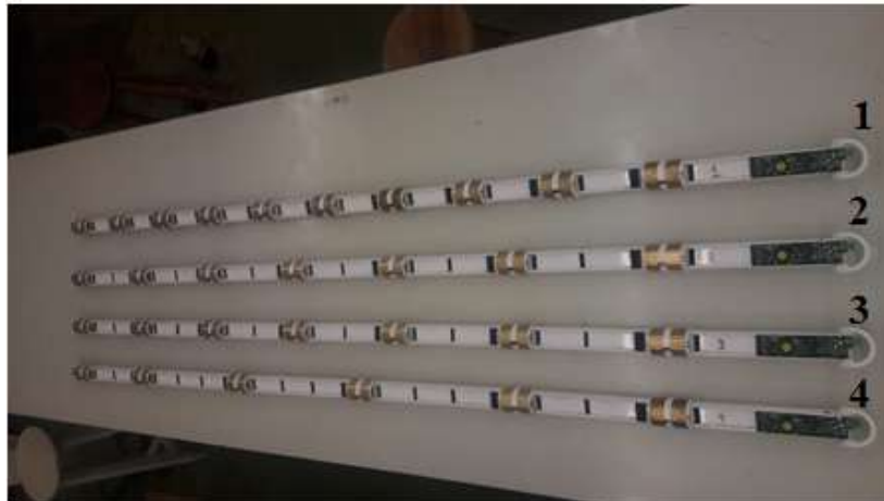
Figura 3.11 - Sondas de medição de umidade com os sensores instalados
