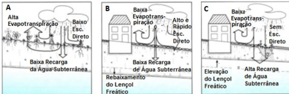
Figura 2.17 - Relação entre a impermeabilização do solo e o balanço de água (evapotranspiração, escoamento direto, recarga de águas subterrâneas e lençol freático): (A) condição natural; (B) urbanização sem implantação das técnicas de infiltração; (C) urbanização com implantação das técnicas de infiltração
