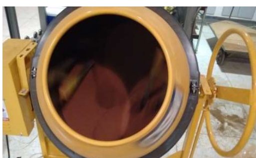
Figura A3 - Procedimento de mistura do solo com água
