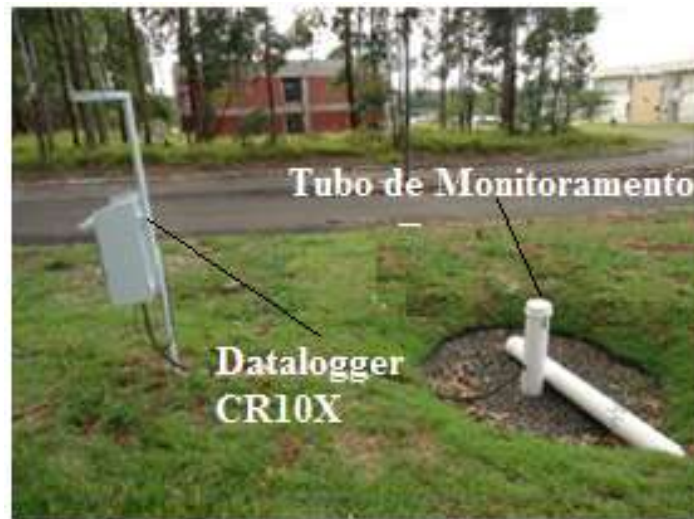
Figura 3.9 - Monitoramento do nível de água no poço GHidro
