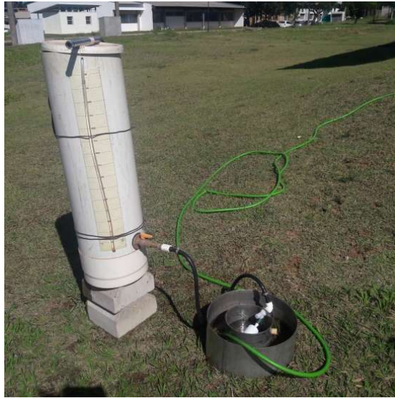
Figura 2.16 - Ensaio do Infiltrômetro de Duplo Anel
