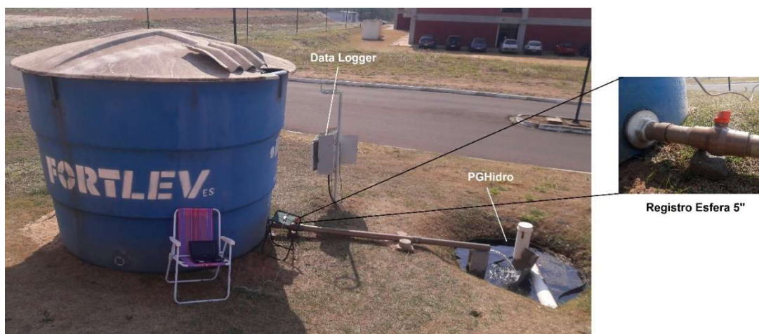
Figura 4.5 - Ensaio com chuva simulada no PGHidro
