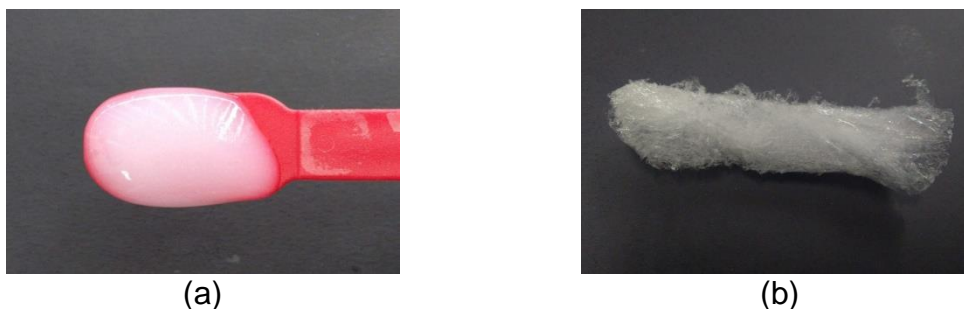
FIGURA 4.10- Imagens da (a) suspensão de nanofibras de celulose e (b) das nanofibras de celulose secas.
