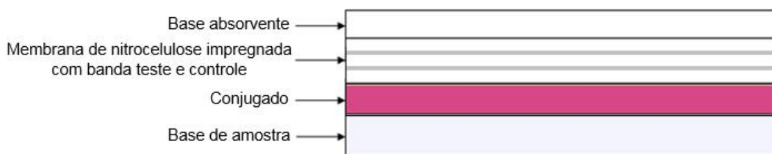
Figura 3: Estrutura da placa montada mostrando a sobreposição das diversas membranas.
