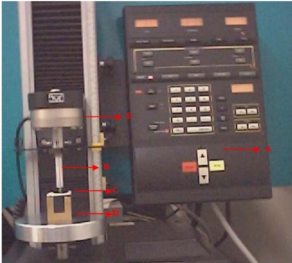
FIGURA 1. Foto da máquina de ensaio universal Instron (modelo 4444) demonstrando um teste de flexão a três pontos em um fêmur de rato. A: painel de controle; B: haste cilíndrica para a aplicação de carga (força); C: osso; D: suporte; E: célula de carga ligada à ponte de extensimetria.
