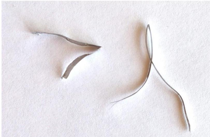
Figura 5.3 - Amostras representativas das fitas de liga Fe-26Cr-11,5Ni-1B (esquerda) e Fe-26Cr-9Ni-1,5B (direita), após tratamento térmico a 900°C. Fitas dobradas a 180° sem sinais de fratura.
