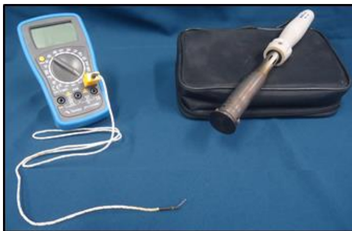
Figura 2: Multímetro Digital Et-1110a Minipa utilizado para aferição de temperatura e aparelho de ferro de solda, placa de alumínio circular com diâmetro de 3cm.
