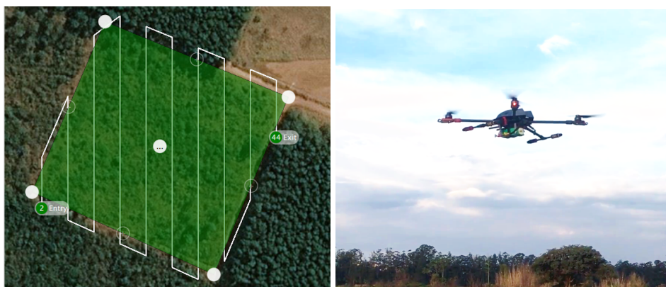
Figura 5.5: Planejamento de Voo. Em (a) planejamento da missão usando como Software QGround , e em (b) o UAV.
