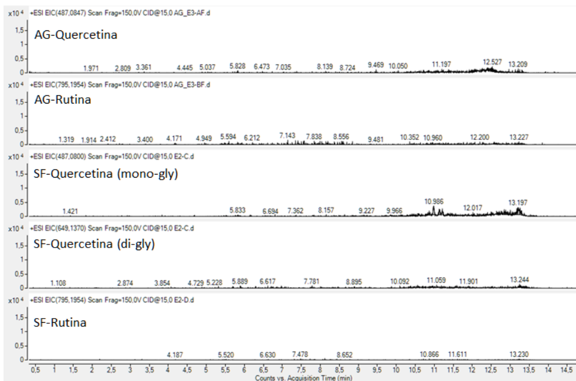
FIGURA A.3: Cromatograma de EIC para os grupos controle dos ensaios enzimáticos.
