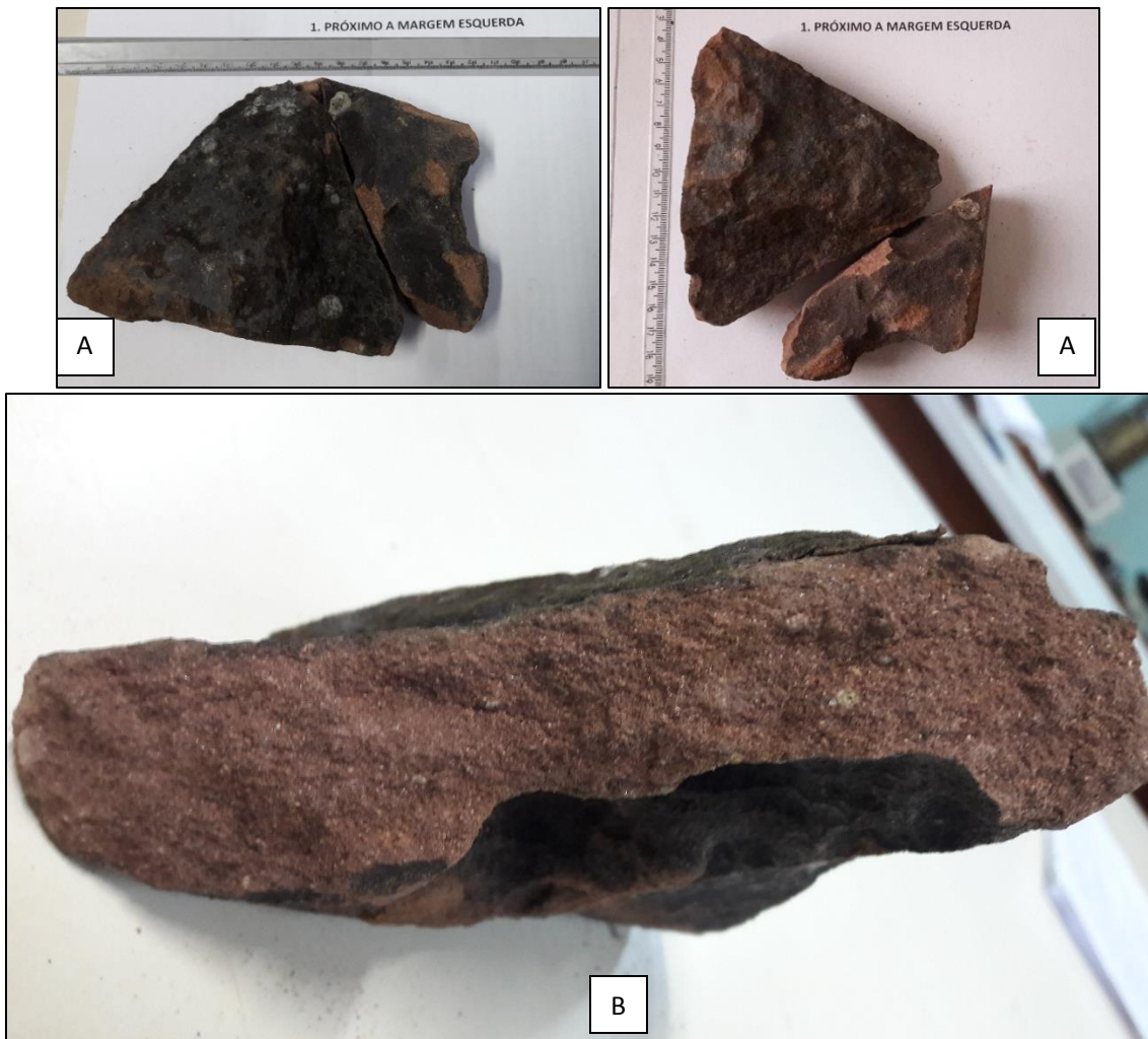
Figura 77. Rocha sedimentar arenítica coletada no fundo do canal. Em que (A) Rocha Fragmentada com ataque dos organismos; (B) Grãos de Quartzo Foto: Leila Nalis Paiva da Silva Andrade
