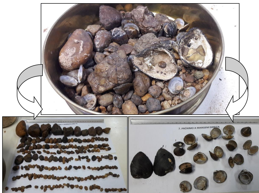
Figura 80. Diferentes formas e tamanhos dos grãos e conchas encontradas no fundo do canal no P7 a jusante da UHE Colíder no rio Teles Pires
