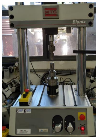
Figura 4.4 - Máquina servo-hidráulica utilizada nos ensaios de fadiga.
