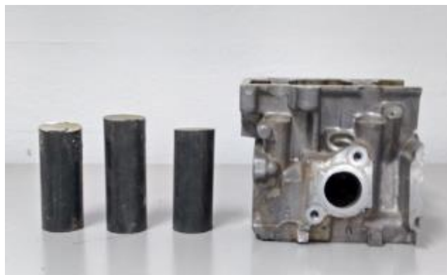
Figura 4.1 - Matérias primas recicladas utilizadas na fabricação do aço de baixa densidade estudado. Aço estrutural 1020 à esquerda e bloco de motor constituído pela liga de alumínio A380 à direita.
