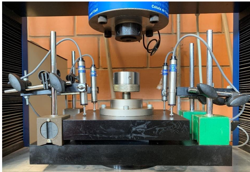
Figura 3.15: Vista frontal do esquema de ensaio de compressão.
