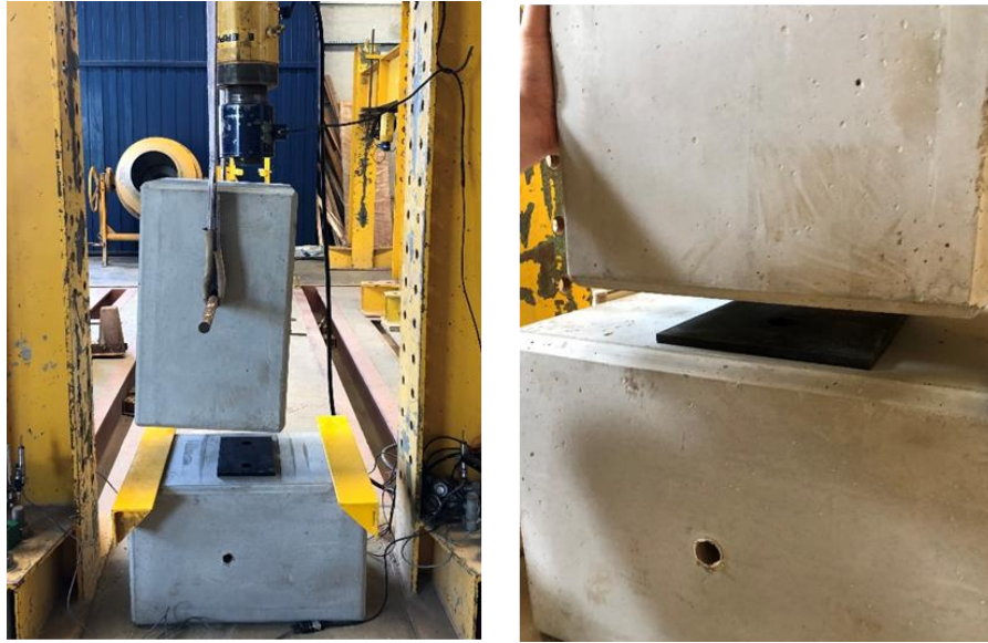
Figura 5.9: Posicionamento do bloco B02.
