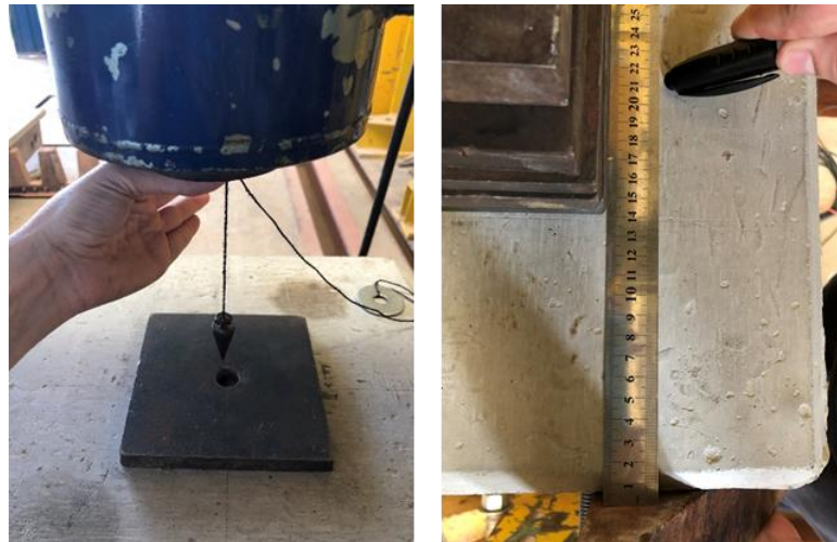
Figura 5.10: Posicionamento da rótula para receber o carregamento.
