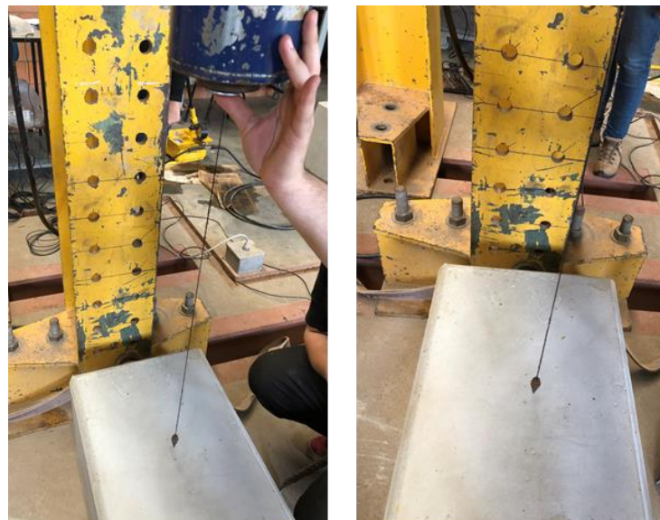
Figura 5.8: Verificação do posicionamento do bloco B01.
