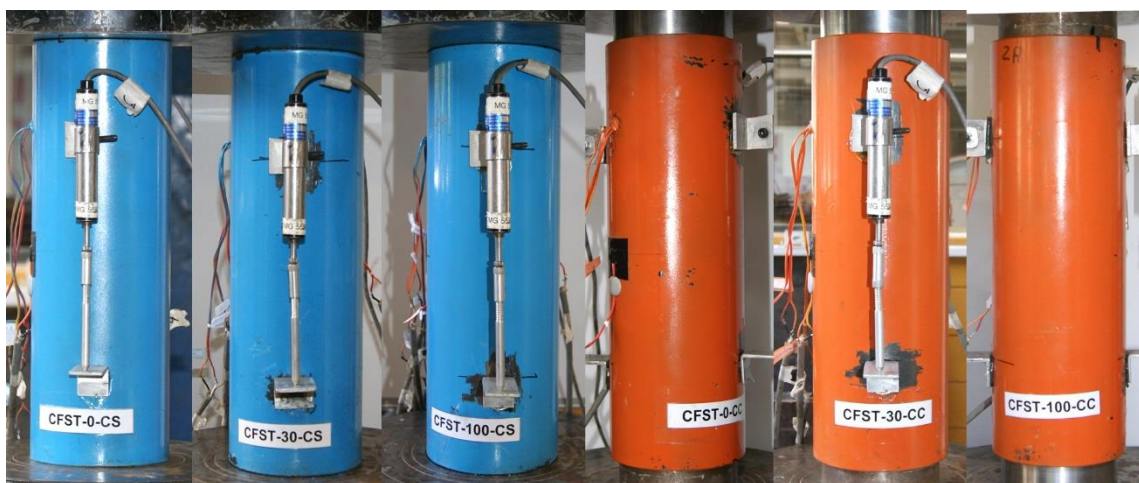
Figura 7.1. PPCARC submetidos a compressão axial centrada
