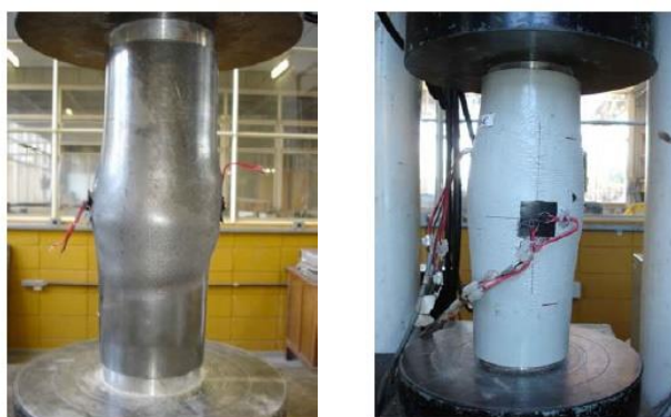
Figura 3.12. Modos de falha em pilares curtos com diferentes esbeltezes locais
