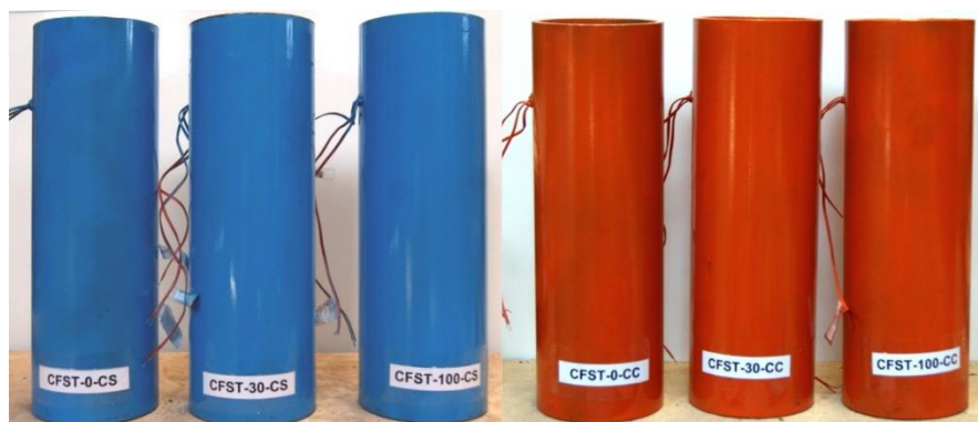
Figura 5.21. Pilares concretados e pintados
