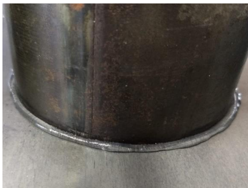
a) Fixação dos tubos nas bases metálicas
