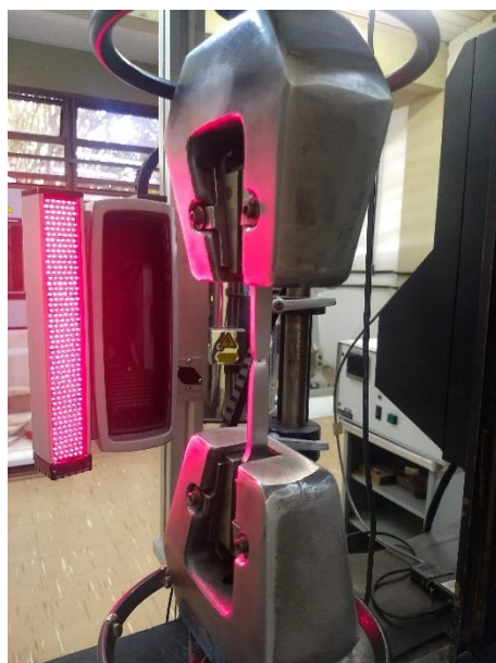
a) Ensaio de tração e medição ótica
