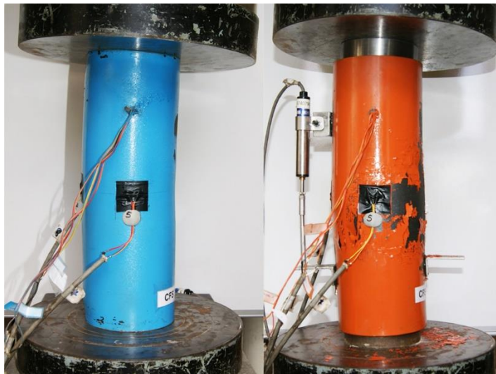
Figura 7.3. Exemplares CFST-0-CS e CFST-30-CC submetidos a flexo-compressão
