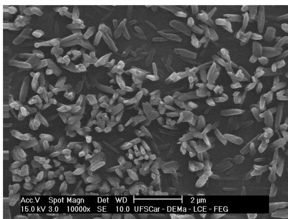
Figura 4.40 - Micrografia por MEV da mistura  $H_3BO_3/C_3H_6N_6$  pré-calcinada convencionalmente a 200 °C/1h e 300 °C/2h em  $N_2$  (precursor de
