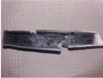
Figura 4.6 - Fotografia de um cadinho de alumina-mulita com a amostra após reação de óxido de boro com negro de fumo.
