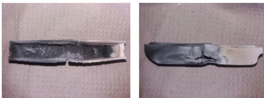
Figura 4.21 - Fotografia de um cadinho de alumina-mulita com a amostra após reação de óxido de boro com carvão ativado.
