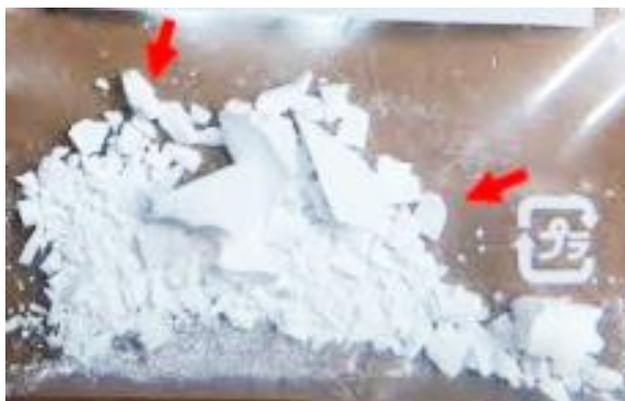
**Figura 4.8.** Pastilha sinterizada quebrada. As setas apontam as amostras potenciais para levitação.
