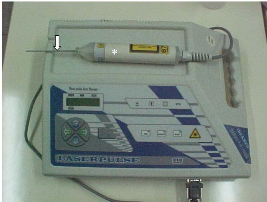
**Figura 2:** Equipamento contendo o diodo responsável pela emissão de radiação LASER no  $\lambda$  de 670 nm. É possível visualizar a adaptação da fibra ótica (seta) realizada na extremidade da probe de emissão (\*).
