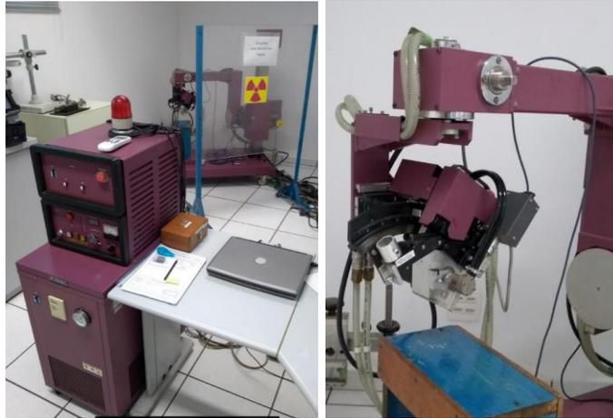
Figura 3.17 - Difratorômetro Rigaku MSF-3M do Centro de Pesquisa e Desenvolvimento da Villares Metals S.A.
