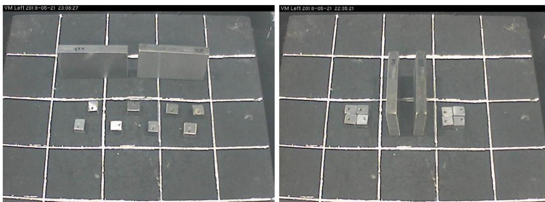
Figura 3.5 – Amostras de VEX e VH13 antes do tratamento t rmico, respectivamente.
