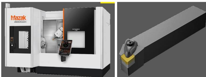
Figura 3.18 - Torno CNC MAZAK Integrex J-300 e ferramenta de corte utilizada.
