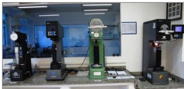
Figura 3.11 – Durômetros Brinell e Rockwell do Laboratório Metalográfico da Villares Metals S.A.
