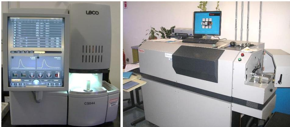
Figura 3.3 – Imagem dos equipamentos CS844 e ARL4460, respectivamente.
