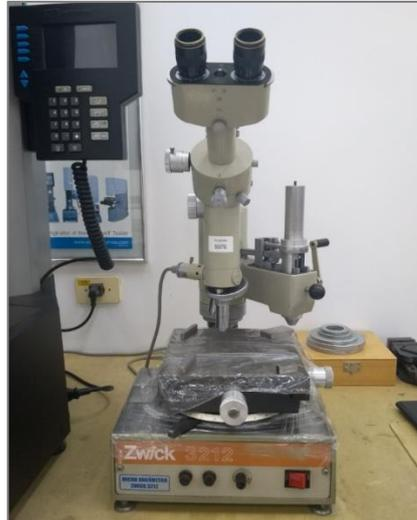
Figura 3.10 – Microdurômetro Zwick 3212 do Centro de Pesquisa e Desenvolvimento da Villares Metals S.A.
