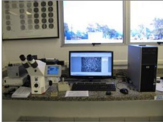
Figura 3.7 – Microscópio ótico Zeiss Observer.Z1m do Laboratório Metalográfico da Villares Metals.
