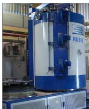
Figura 3.6 – Forno de nitretação a plasma do Centro de Serviços de Tratamentos Térmicos da Villares Metals S.A.
