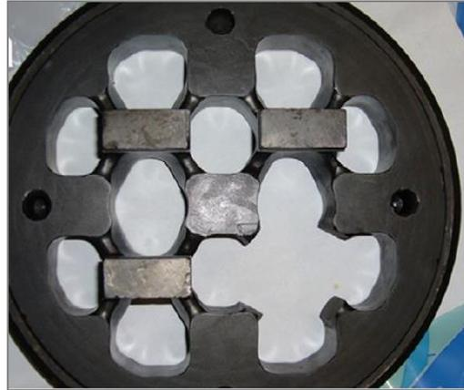
Figura 2.8 – Falha catastrófica ocasionada por fadiga termomecânica. [13]
