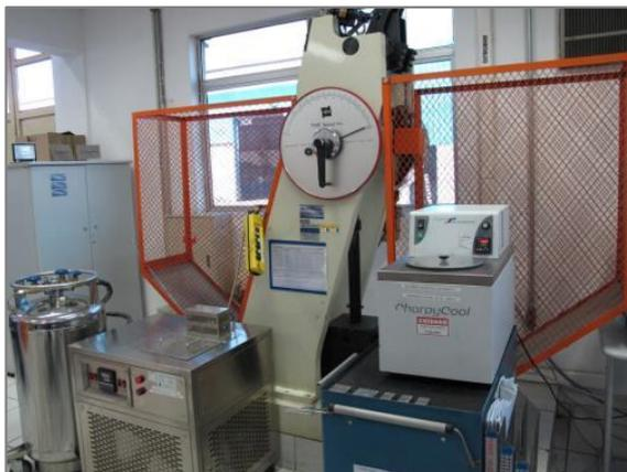
Figura 3.13 – Máquina de ensaios de impacto do Laboratório de Ensaios Mecânicos da Villares Metals S.A.
