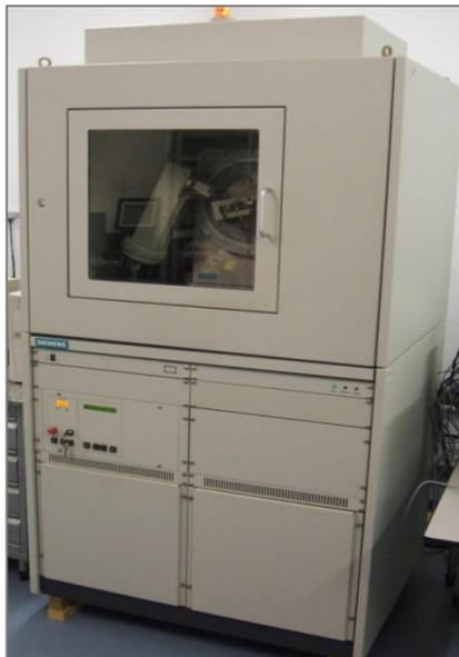
Figura 3.16 – Difratômetro Siemens D5005 do Laboratório de Caracterização Estrutural da UFScar.
