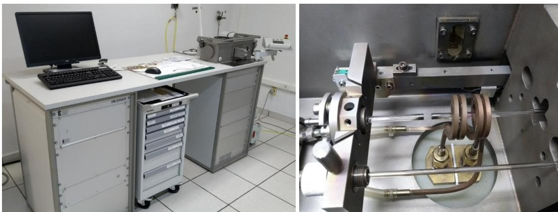
Figura 3.12 – Dilatômetro de alta precisão modelo DIL805A/D do Centro de Pesquisa e Desenvolvimento da Villares Metals S.A.
