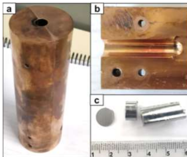
Figura 4.3.1.3. a) molde de cobre utilizado para a solidificação dos lingotes, b) seção transversal do molde de solidificação e c) lingote cortado em formato de discos.
