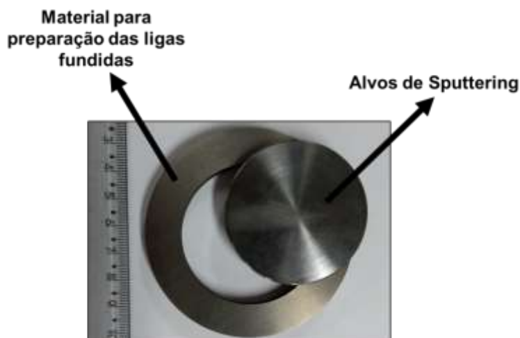
Figura 4.2.1.1. Alvos e material para preparar as ligas fundidas.
