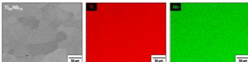
Figura 5.2.9.1. Micrografias obtidas por MEV que mostram os mapas elementares de EDS da amostra Ti_{50}Nb_{20} com a distribuição de Ti e Nb.
