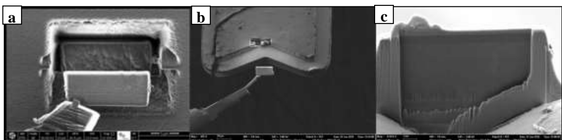
Figura 4.4.2.3.5. Imagens de HRSEM descrevendo a etapa 4 do processo de preparação de amostra FIB: a) retirada da amostra, b) soldagem na agulha de cobre e c) afinamento inicial.
