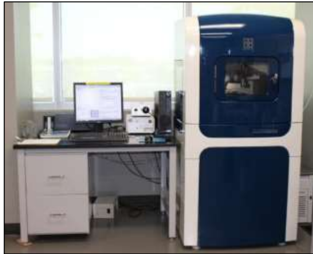
Figura 4.5.4.3. Tribometro Ti 950 localizado no LFS/Poli/USP.
