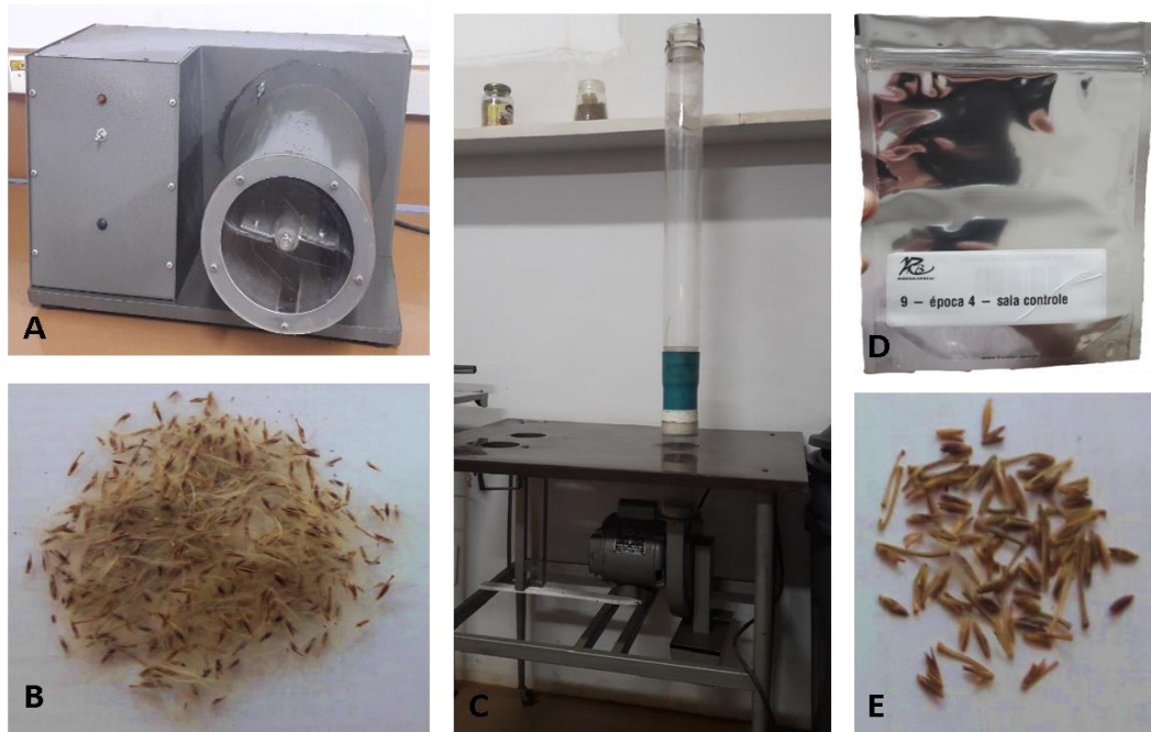
FIGURA 3. (A) EQUIPAMENTO PARA DESLINTAMENTO DE SEMENTES, (B) SEMENTES COM LÍNTER, (C) INSUFLADOR PARA REMOÇÃO DO LÍNTER, (D) SACOS METALIZADOS PARA EMBALAGEM DAS SEMENTES, (E) SEMENTES SEM LÍNTER. FONTE: WELLINGTON QUADROS TANNO
