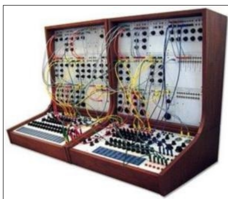
Figura 2: Sintetizador modular Buchla Series 100 (fonte: http://www.ufrgs.br/mvs )
