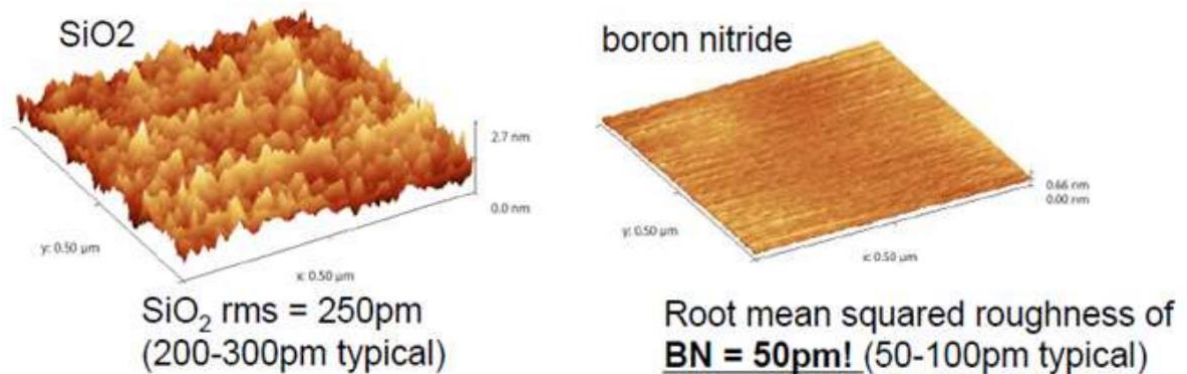
FIGURA 16: Diferença de rugosidade entre substratos. Medida de espectroscopia de força atômica (AFM) em amostras de SiO 2 e h-BN.
