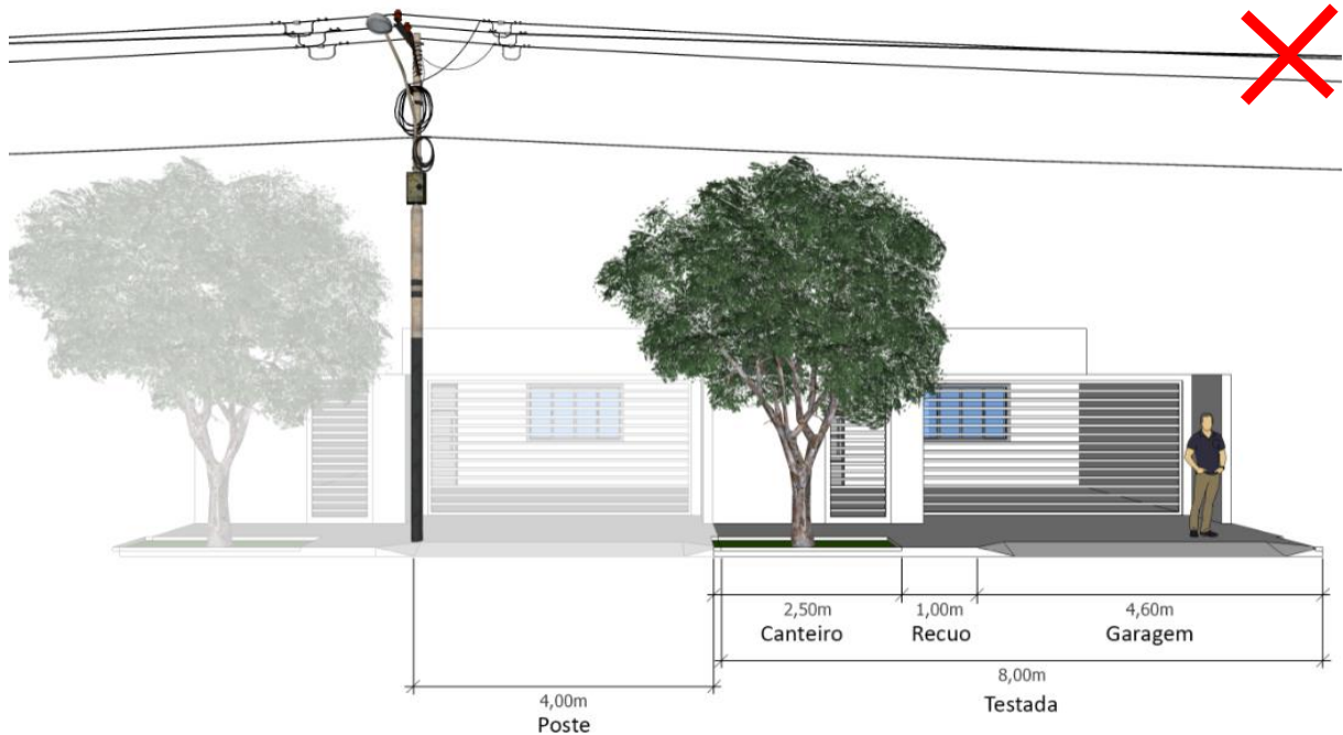
Figura 38: Cenário Lote com poste de energia – Testada 8,0 m.
