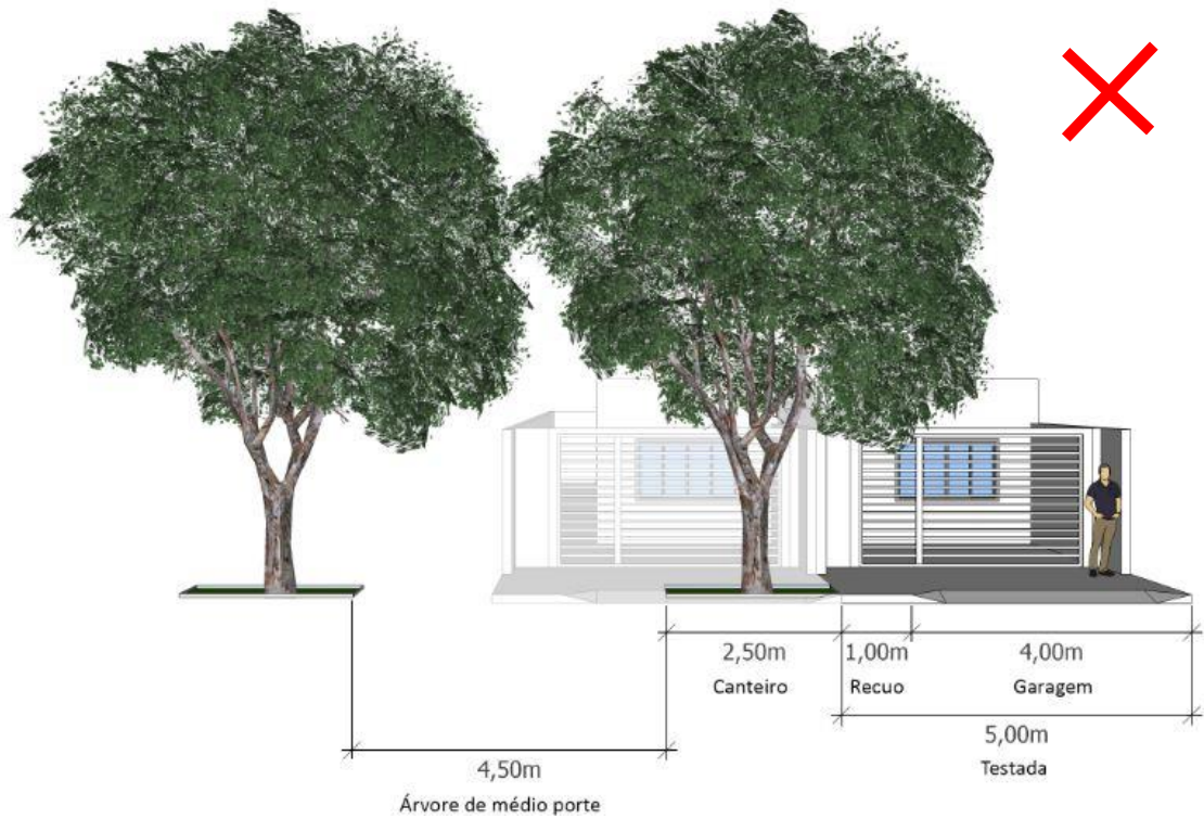
Figura 22: Cenário Lote com árvores de médio porte – Testada 5,0 m Fonte: Elaboração própria
