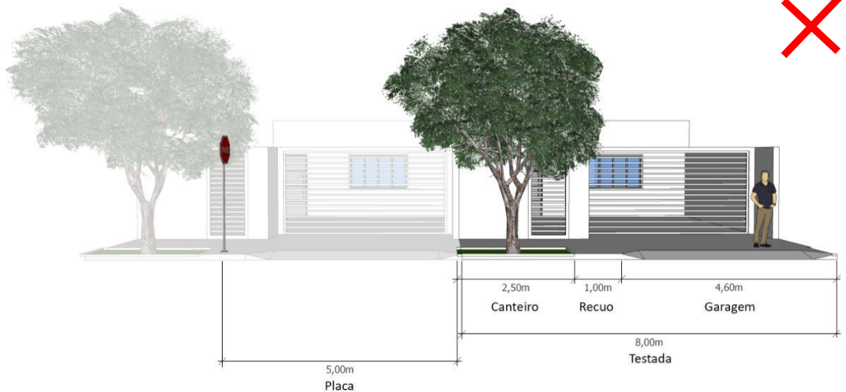
Figura 39: Cenário Lote com placas de sinalização de trânsito – Testada 8,0 m.
