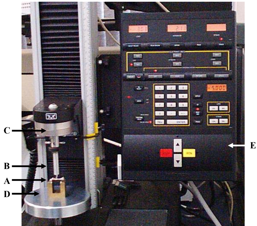
Figura 2: Detalhe da máquina de ensaio universal (modelo Instron 4444) durante teste de flexão a três pontos. A, osso; B, haste cilíndrica para aplicação da carga; C, célula de carga acoplada à ponte de extensimetria; D, suporte para o material analisado; E, painel de controle dos parâmetros analisados
