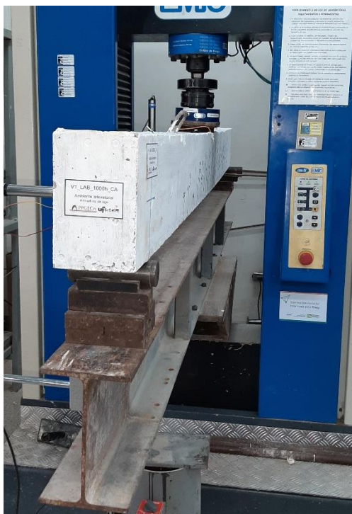
Figura 27: Configuração de ensaio de flexão de três pontos
