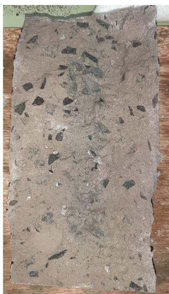
Figura 38: Corpo de prova (a) e face lateral da viga (b) após aspersão da solução de nitrato de prata
