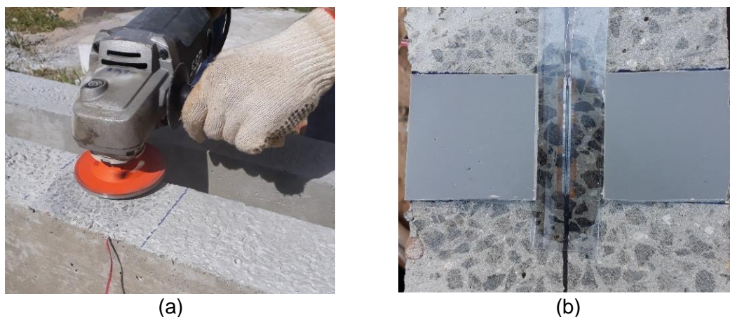
Figura 30: (a) lixamento da superfície de concreto; (b) extensômetro colado
