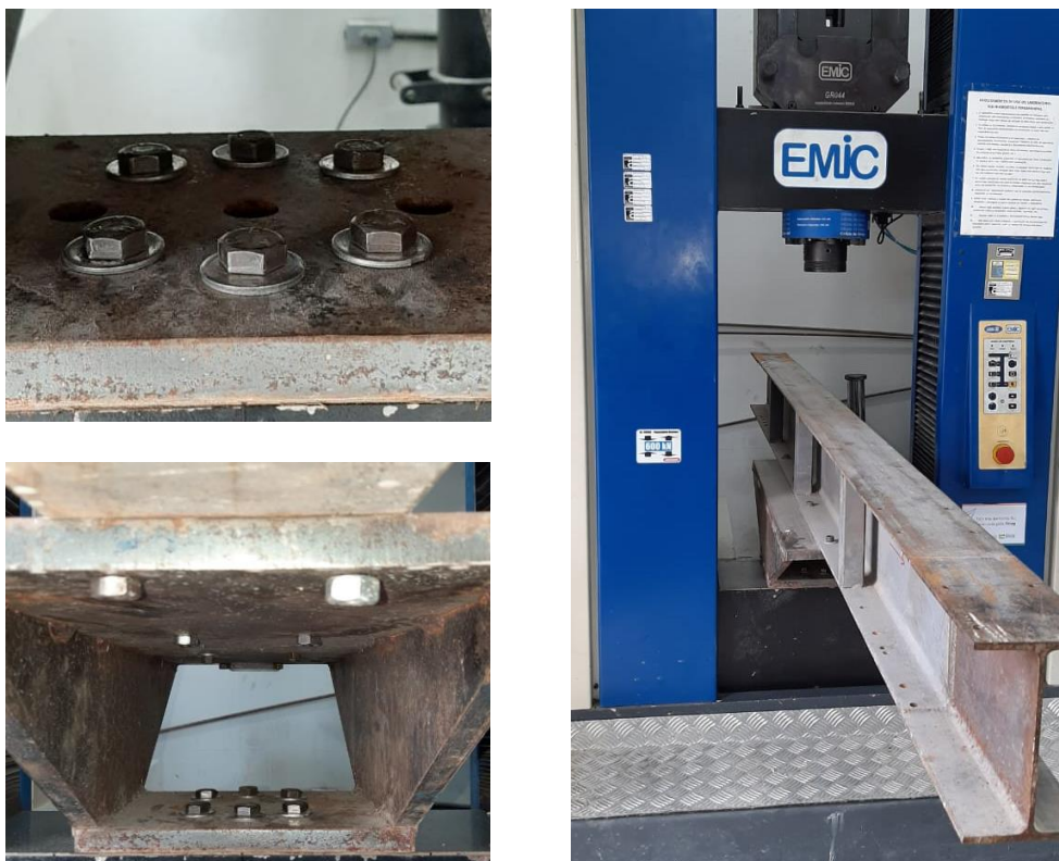
Figura 26: Fixação da peça rígida de aço e composição final do dispositivo
