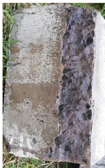
Figura 38: Corpo de prova (a) e face lateral da viga (b) após aspersão da solução de nitrato de prata
