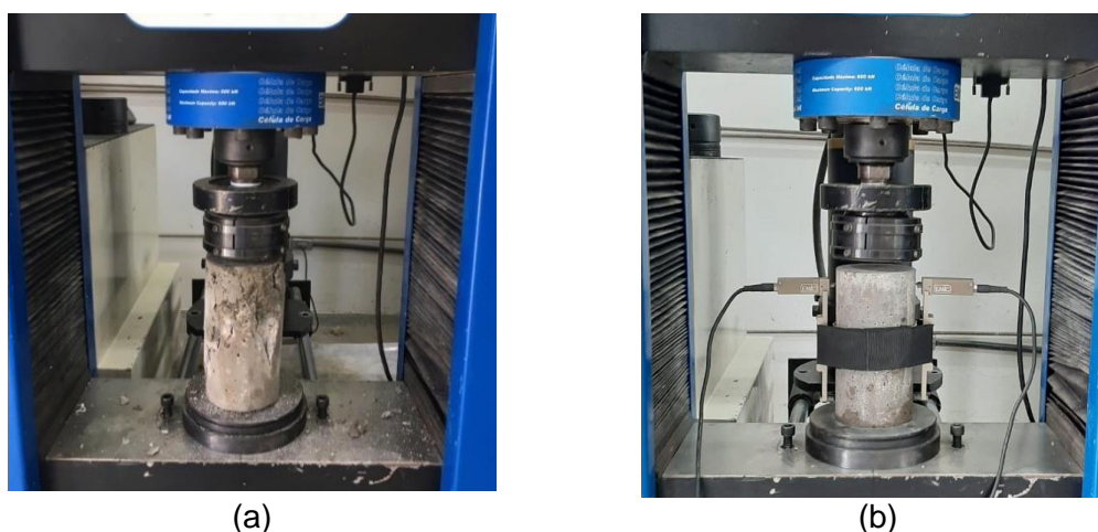
Figura 34: Ensaios de caracterização do concreto: (a) resistência à compressão e (b) determinação do módulo de elasticidade
