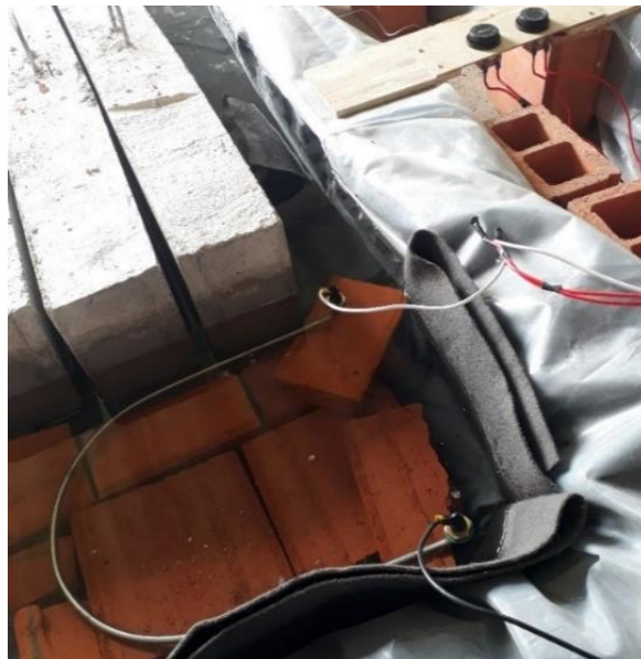
Figura 20: Sistema de aquecimento da solução de NaCl
