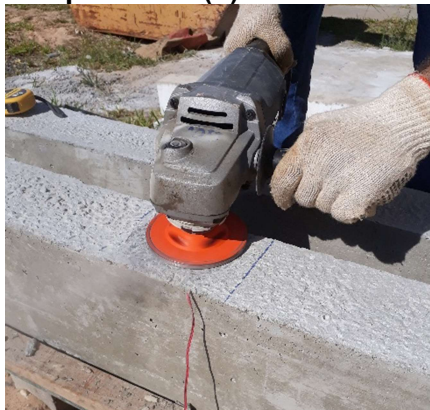
Figura 42: Aplicação do extensômetro elétrico no concreto: (a) preparação da superfície e (b) SG colado no centro da viga de concreto armado
