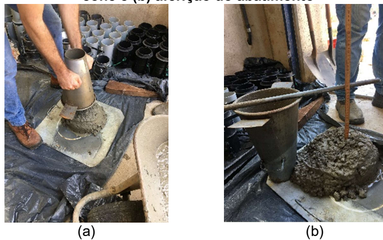
Figura 25: Execução do ensaio de abatimento de cone slump test : (a) remoção do cone e (b) aferição do abatimento
