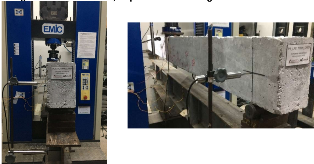
Figura 46: Instrumentação posicionada na viga de concreto armado
