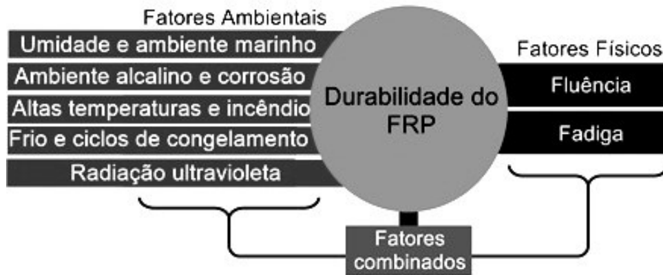
Figura 9: Fatores físicos e químicos que alteram a durabilidade do FRP
