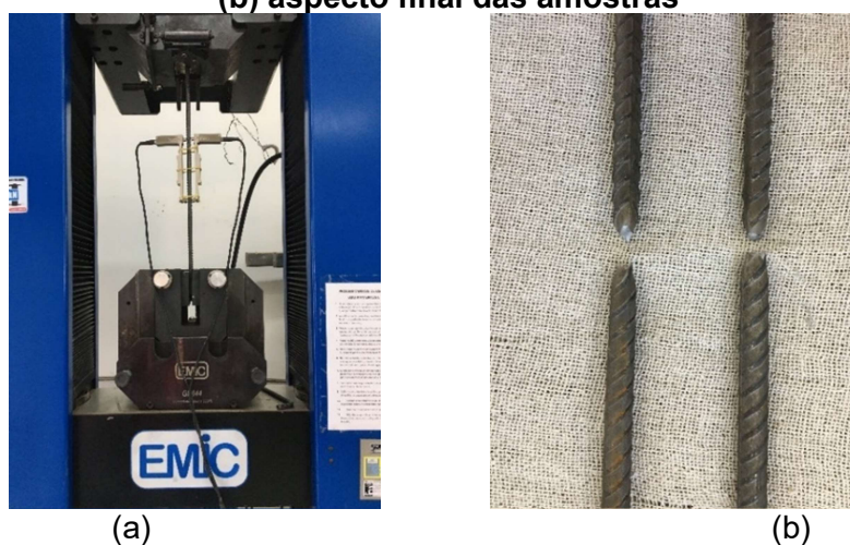
Figura 38: Ensaio de caracterização das propriedades do aço: (a) arranjo de ensaio e (b) aspecto final das amostras
