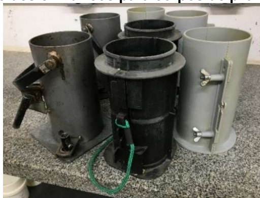
Figura 36: Moldes cilíndricos para corpos de prova de concreto
