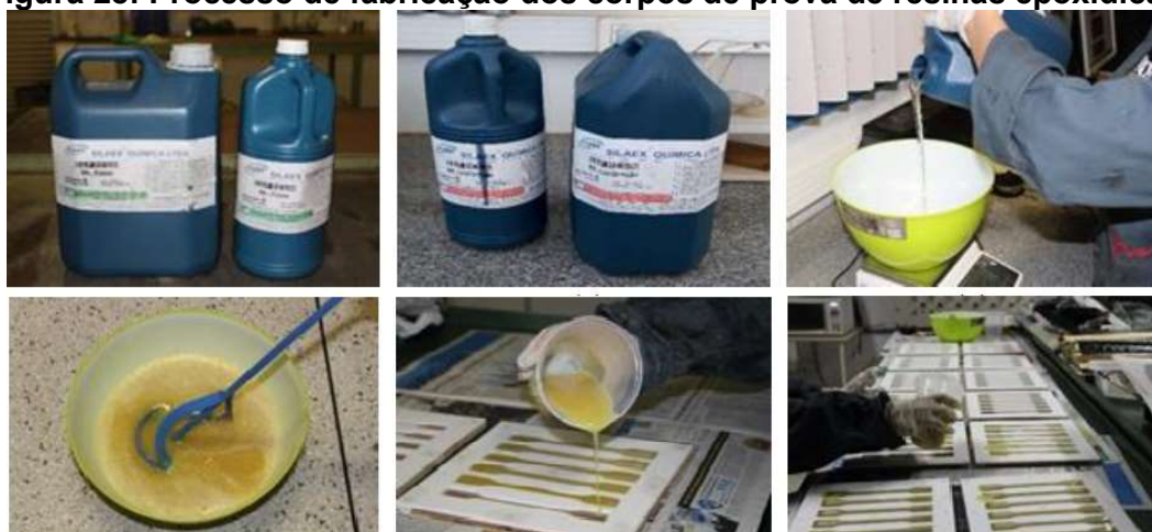
Figura 28: Processo de fabricação dos corpos de prova de resinas epoxídicas
