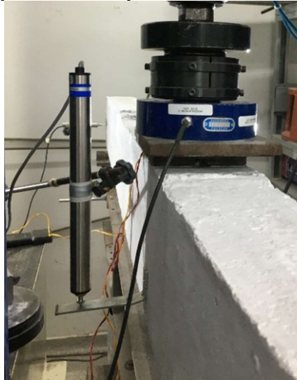
Figura 41: LVDT posicionado para medir o deslocamento vertical
