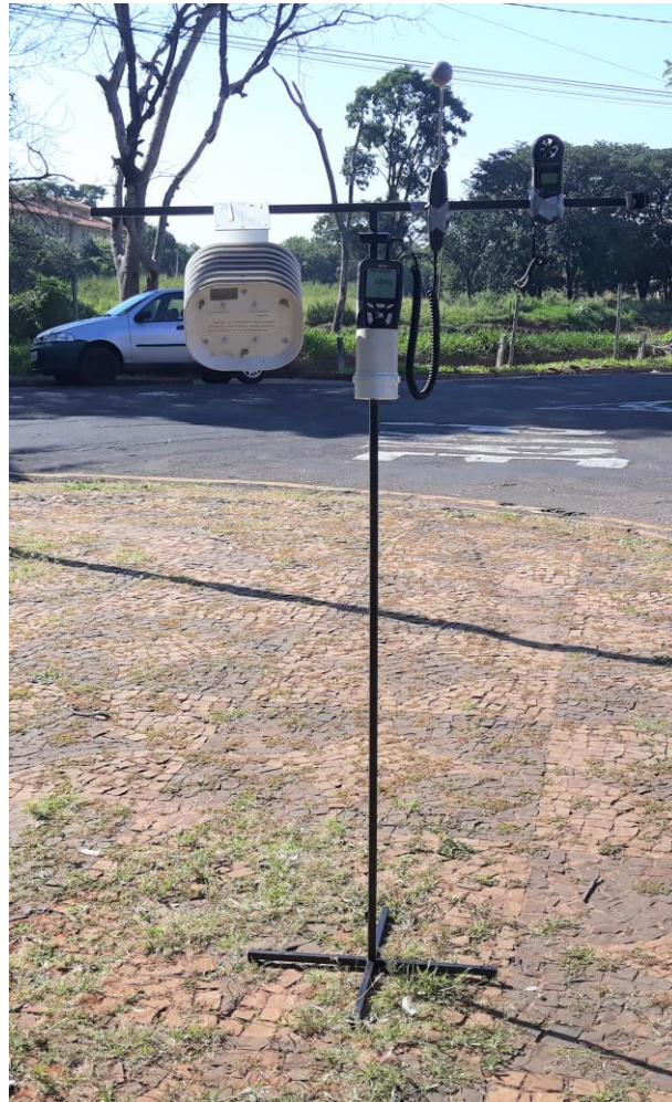
Figura 30 – Exemplo de montagem dos equipamentos para coleta de dados móveis.
