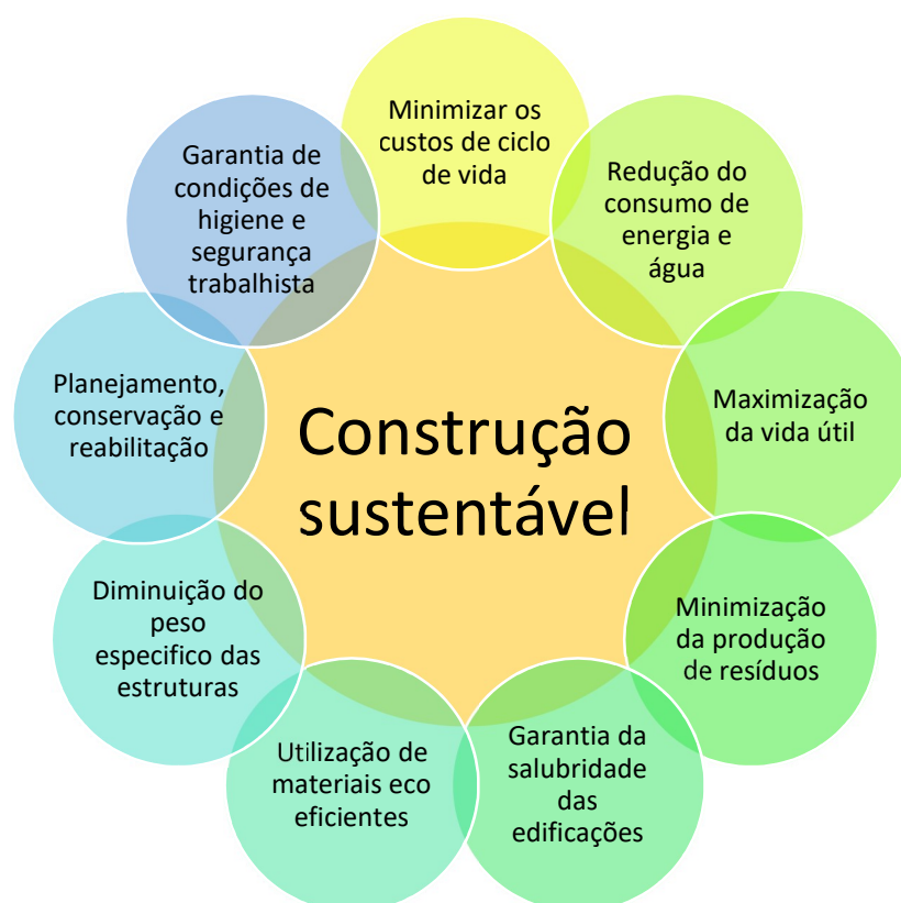
Figura 3.4 – Parâmetros a serem considerado para o alcance de horizontes mais sustentáveis para edificações
