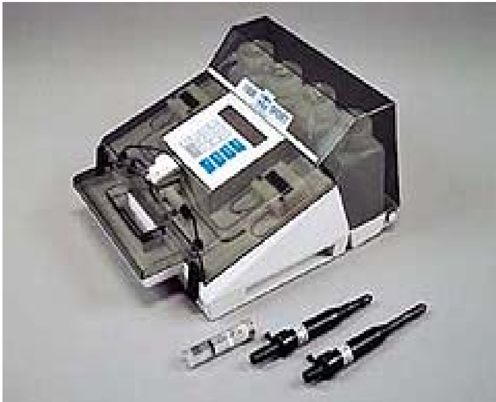
Figura 09. Analisador de lactato eletro-enzimático modelo YSI 1500 Sports da Yellon Springs instruments (Ohio – USA).
