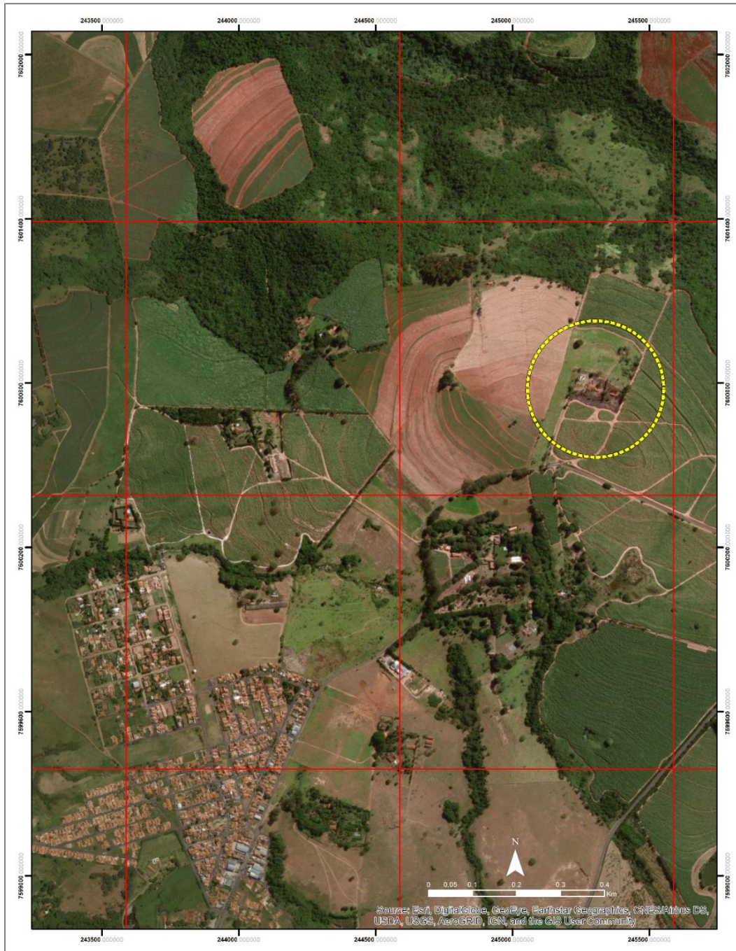
Figura 19: Exemplo de identificação de processos erosivos por meio de imagens de satélite. Em destaque: voçoroca de maior extensão no município de Santa Rita do Passa Quatro (SP). Fonte: Plataforma online de imagens ArcGis® 10.5 – 2018 (imagem Rapid Eye – alta resolução)
